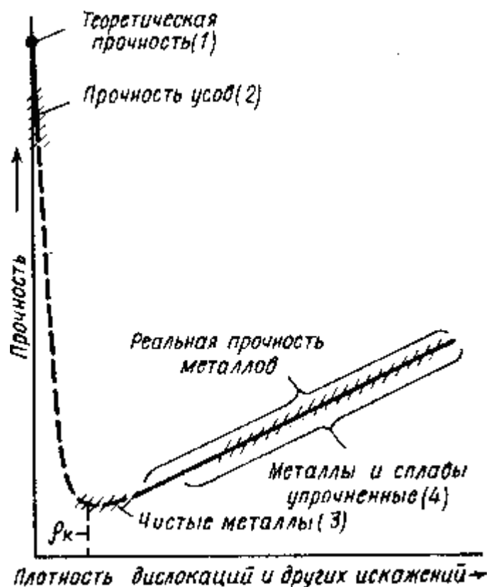
Рис. 2.5. Влияние плотности дислокаций на прочность
