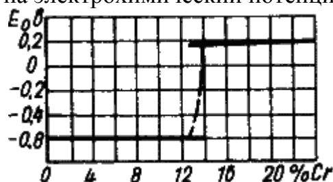
Рис 16.1. Влияние хрома на потенциал сплавов Fe-Cr
