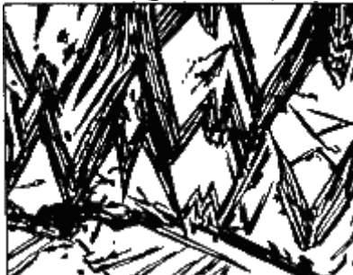
Рис. 12.2. Ориентированность кристаллов мартенсита
