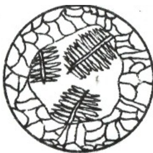
Рис. 2.4. Схема кристаллизации хлористого аммония
