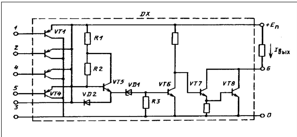
Рис. 12.1. Схема интегрального микроэлемента типа К511ЛИ1
