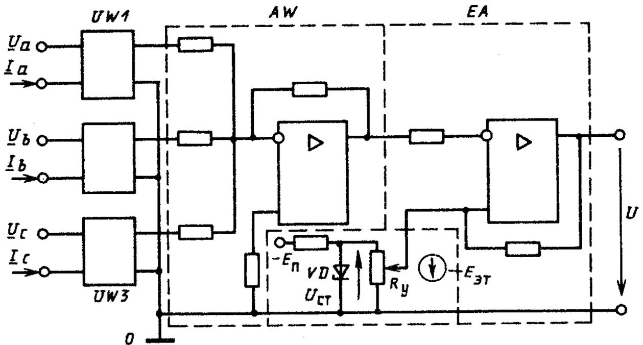
Рис. 9.3. Функциональная схема измерительного органа релейного действия активной мощности
