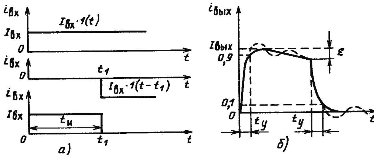
Рис. 11.1. Входной сигнал с прямоугольной формой кривой (а) и выходной сигнал (б) импульсного усилителя
