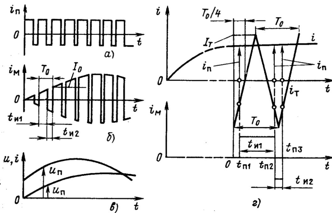
**Рис. 7.2.** Временные диаграммы, поясняющие первый (а, б) и второй (в) способы прямого времяимпульсного перемножения дискретизованных мгновенных значений  $U_n, i_n$  синусоидального напряжения и тока (в)
