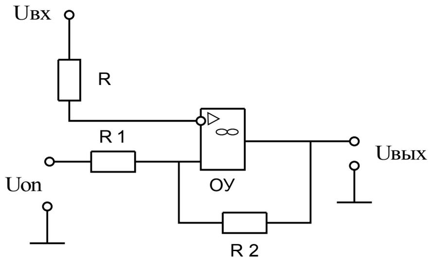
2. Определить пороги срабатывания и ширину петли гистерезиса.
