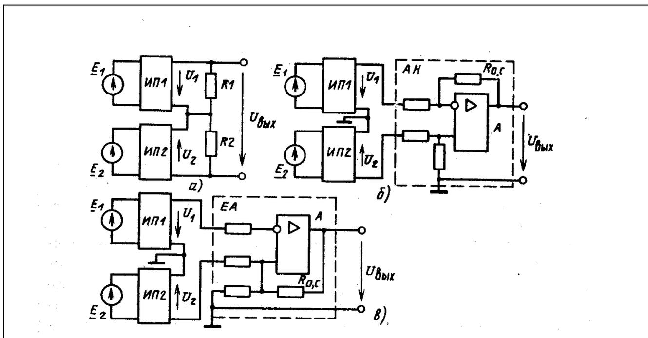
**Рис. 8.1.** Функциональные схемы элементов сравнения сигналов непрерывного (а, б) и релейного (в) действия
