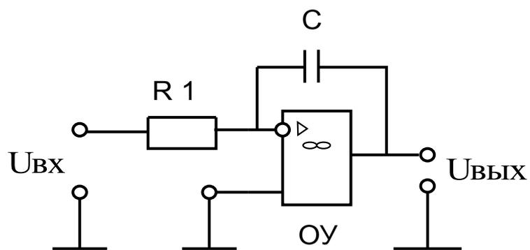
2. Построить зависимость  $U_{\text{ВЫХ}}=f(t)$ ,  $U_{\text{ВХ1}}=10$  мВ. Примечание: ОУ входит в насыщенный режим при  $U_{\text{ВЫХ}}=10$  В.
