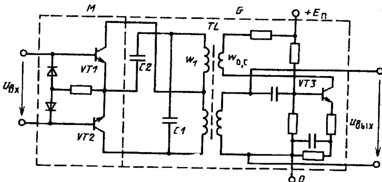
**Рис. 11.3.** Схема частотного манипулятора с управляемым генератором
