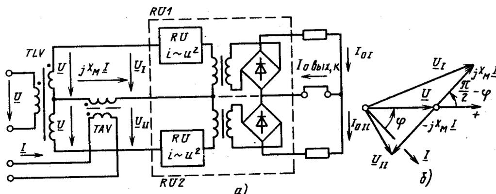
**Рис. 7.4.** Схема (а) и векторная диаграмма (б) измерительного преобразователя реактивной мощности на варисторных квадраторах
