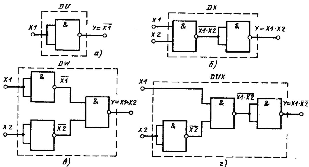
**Рис. 10. 1.** Функциональные схемы логических элементов НЕ (а), И (б), ИЛИ (в) и ЗАПРЕТ (г), выполняемых на интегральных микроэлементах
