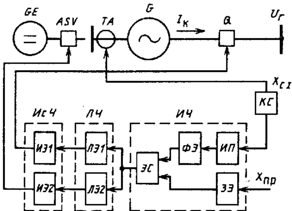
*Рис. 1.4.* Функциональная схема автоматического управляющего устройства релейного действия – автоматической защиты синхронного генератора
