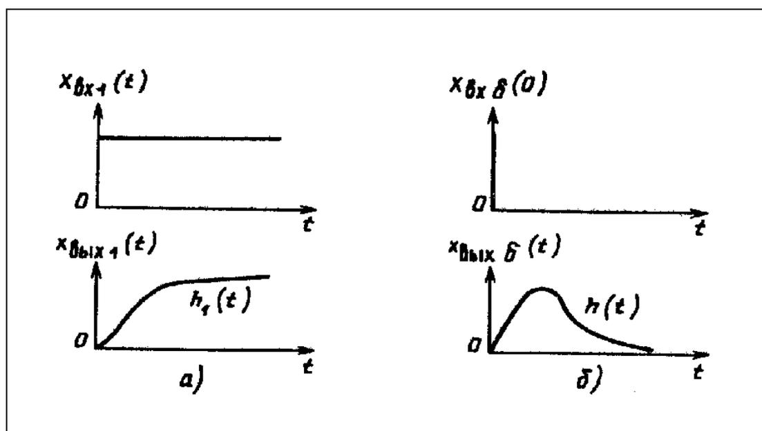
Рис. 2.1. Входной сигнал, описываемый единичной функцией, и непрерывная переходная характеристика (а); входной импульсный сигнал, описываемый  $\delta$
