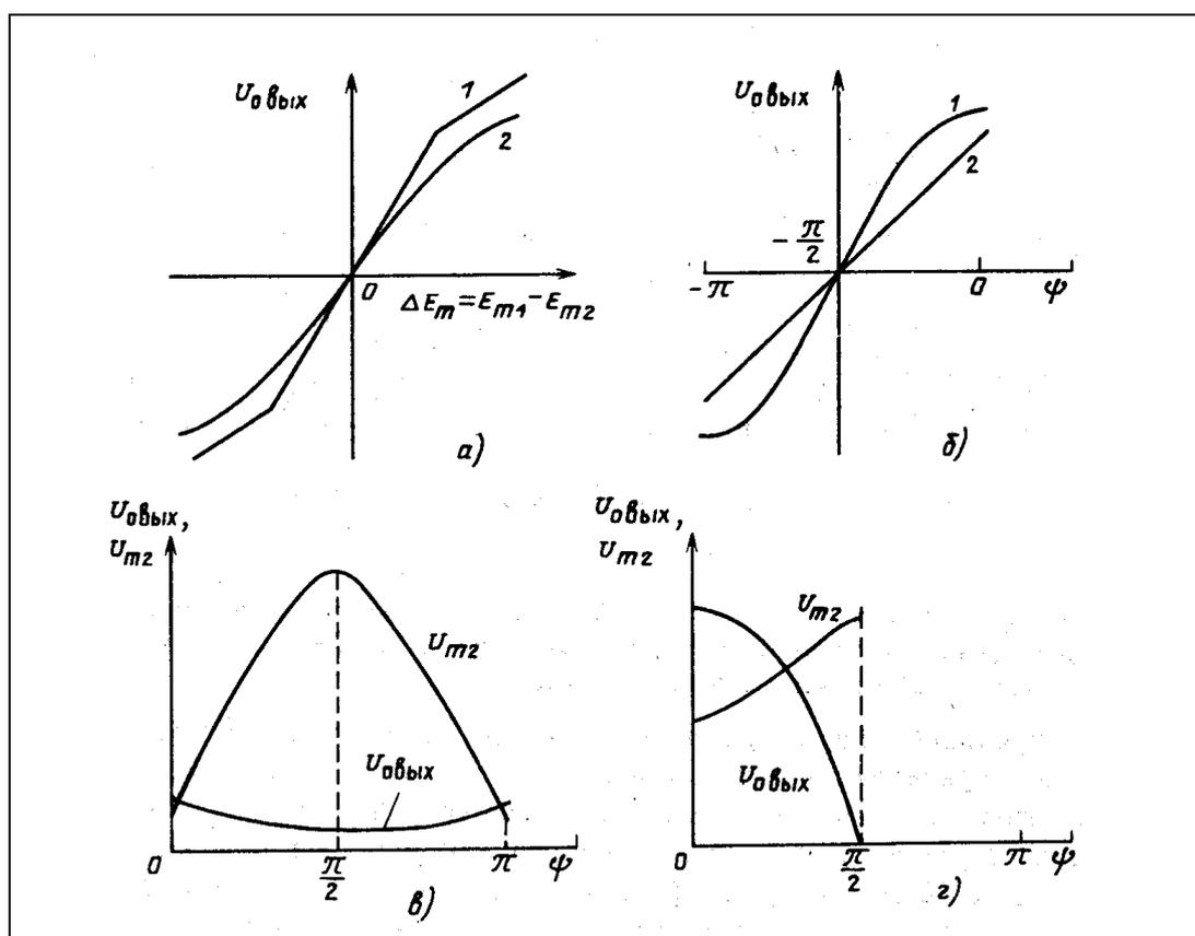
**Рис. 8.6.** Проходные характеристики (а, б) и зависимости сигнала и помехи (в, г) на выходе элементов сравнения амплитуд (а, в) и фаз (б, г)
