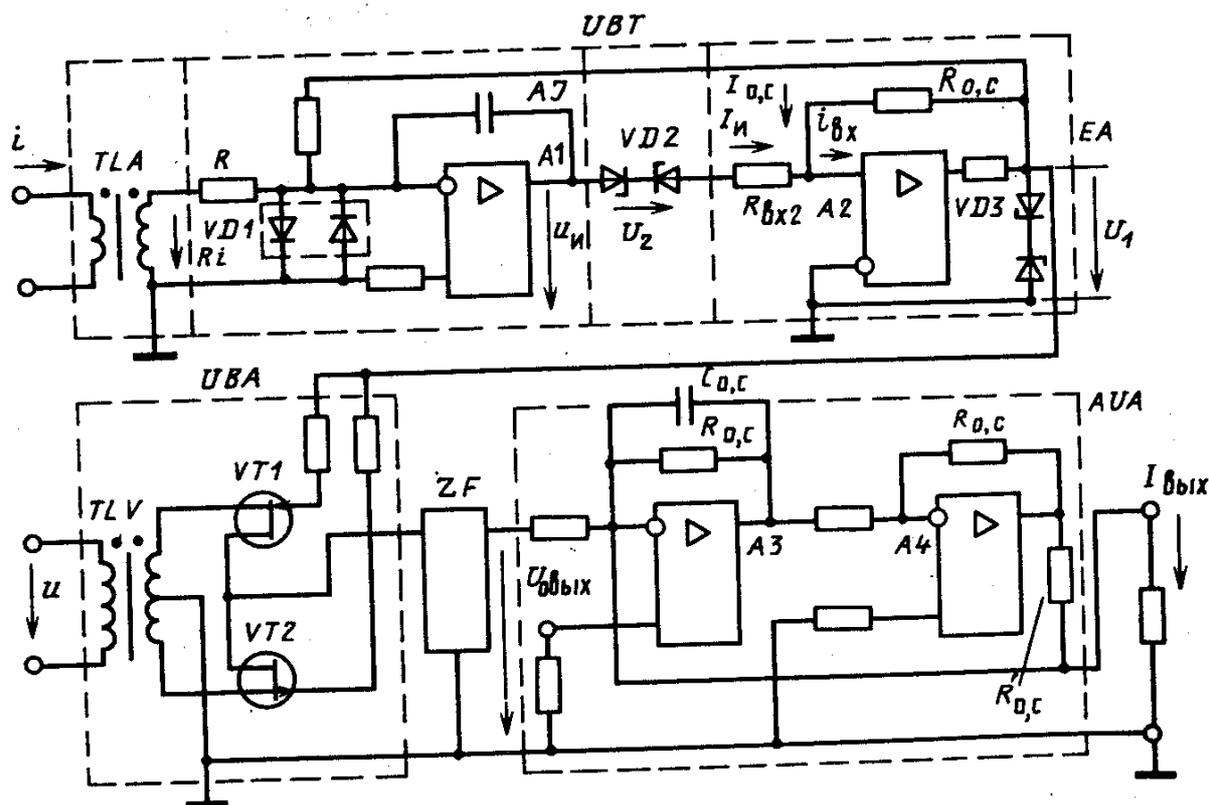
**Рис. 7.5.** Схема времяимпульсного измерительного преобразователя активной мощности с широтно-импульсным модулятором, функционирующим на основе интегрирования перемножаемого напряжения
