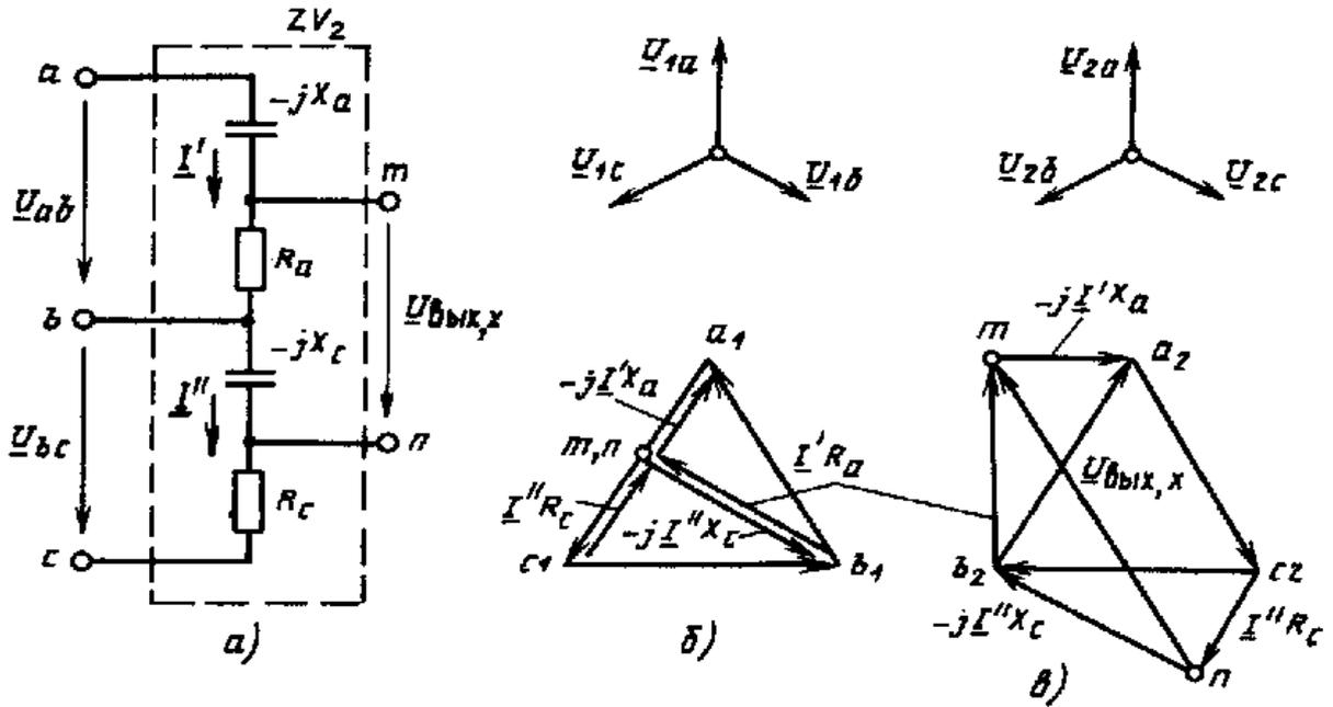
Рис. 6.3. Схема (а) и векторные диаграммы (б, в) резисторно-конденсаторного фильтра напряжения обратной последовательности
