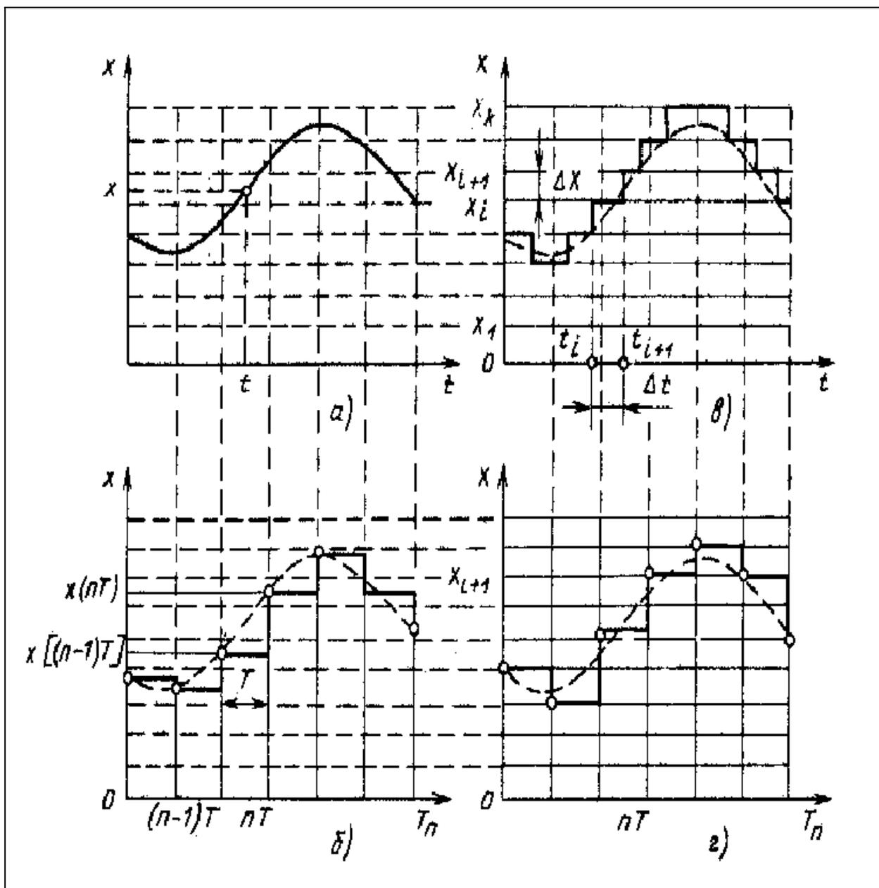
**Рис. 1.2.** Непрерывный (а), дискретно-непрерывный (б), непрерывно-дискретный (в), дискретный (г) сигналы
