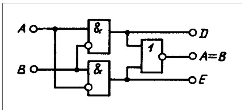
Рис. 8.10. Схема реализации алгоритма сравнения одноразрядных чисел
