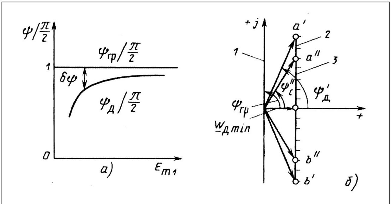
**Рис. 8.3.** Графики погрешностей (а) и характеристики действия (б) релейного элемента сравнения фаз
