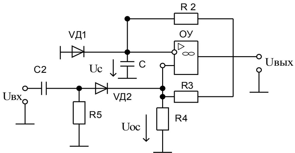
2. Определить максимальную частоту входных импульсов, их амплитуду и длительность при  $C_2=100$  пФ,  $R_5=10$  кОм.
