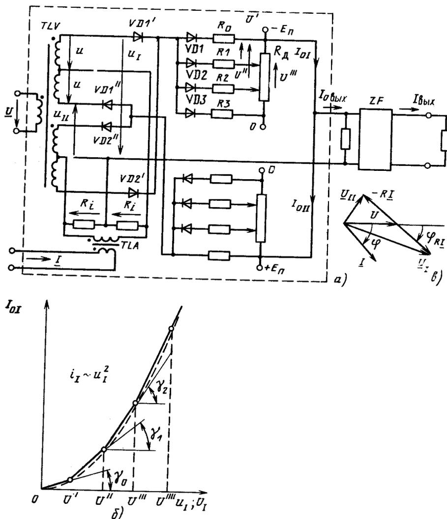
**Рис. 7.3.** Схема (а) и векторная диаграмма (в) измерительного преобразователя активной мощности не диодных квадраторах и их характеристика (б)
