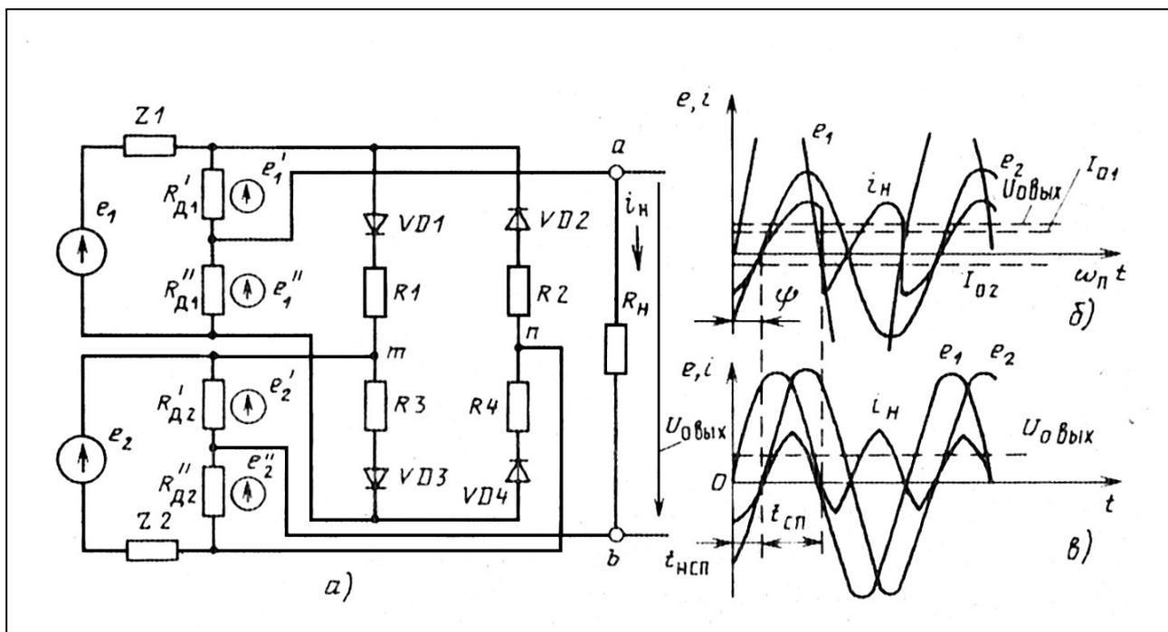
**Рис. 8.5.** Схема элемента сравнения фаз на основе кольцевого диодного демодулятора (а) и его временные диаграммы (б)
