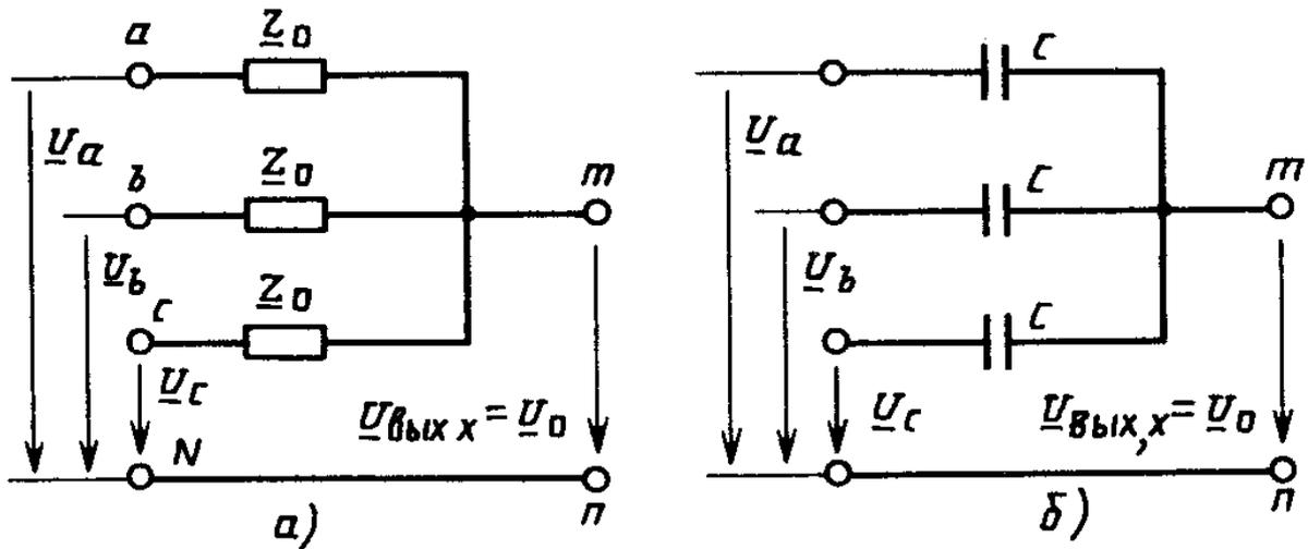
*Рис. 6.2.* Схемы фильтров симметричных составляющих напряжений нулевой последовательности
