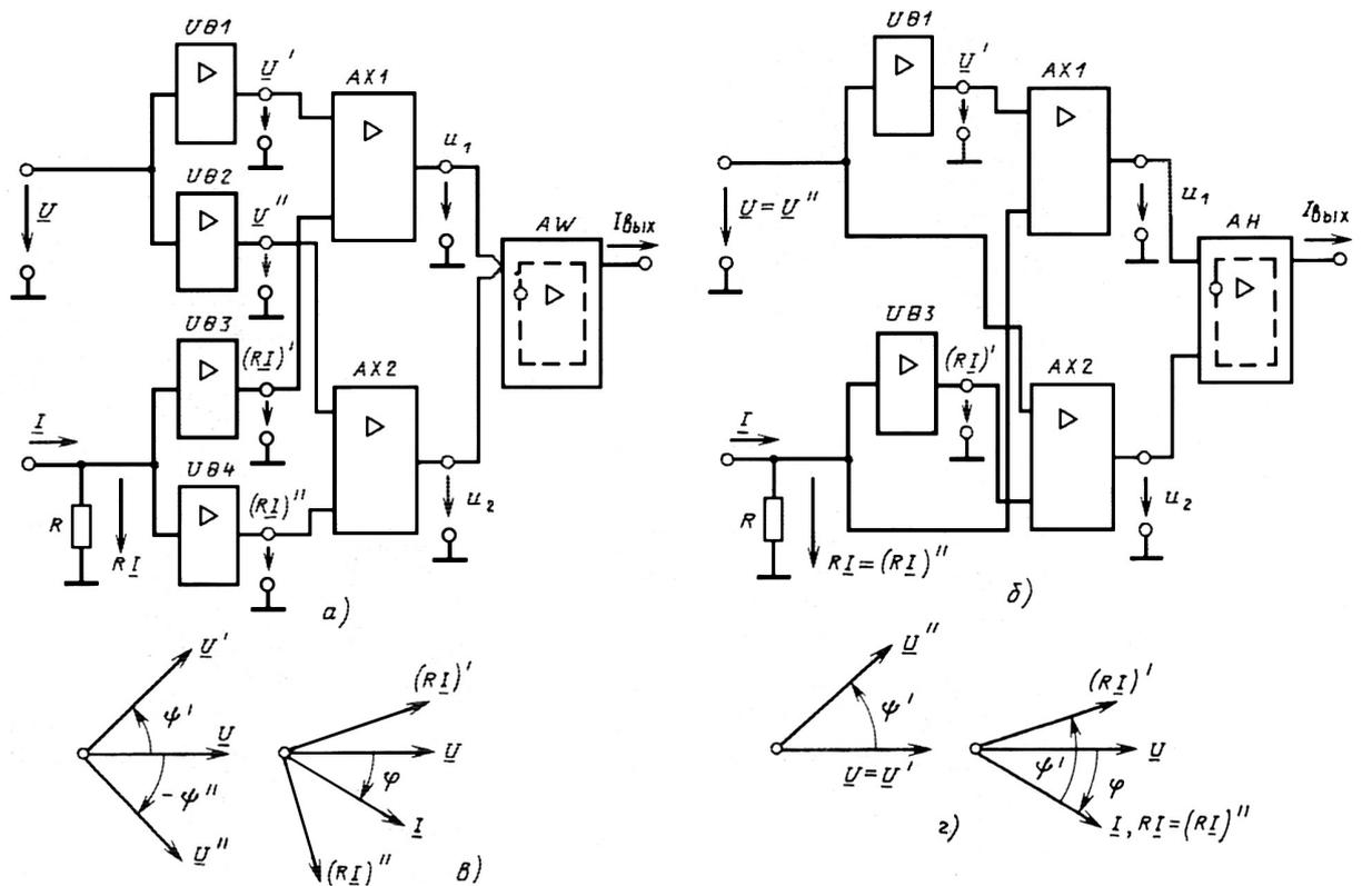
**Рис. 7.6.** Функциональные схемы и векторные диаграммы измерительных преобразователей активной (а) и реактивной (б) мощностей на интегральных перемножителях
