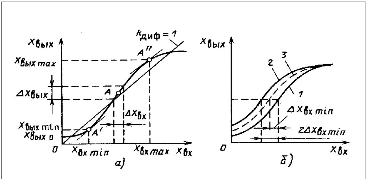
Рис. 2.3. Непрерывные проходные характеристики функционального элемента
