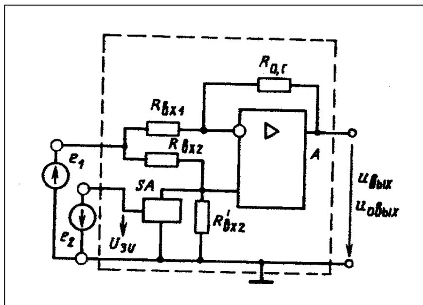
Рис. 8.9. Схема активного элемента сравнения фаз
