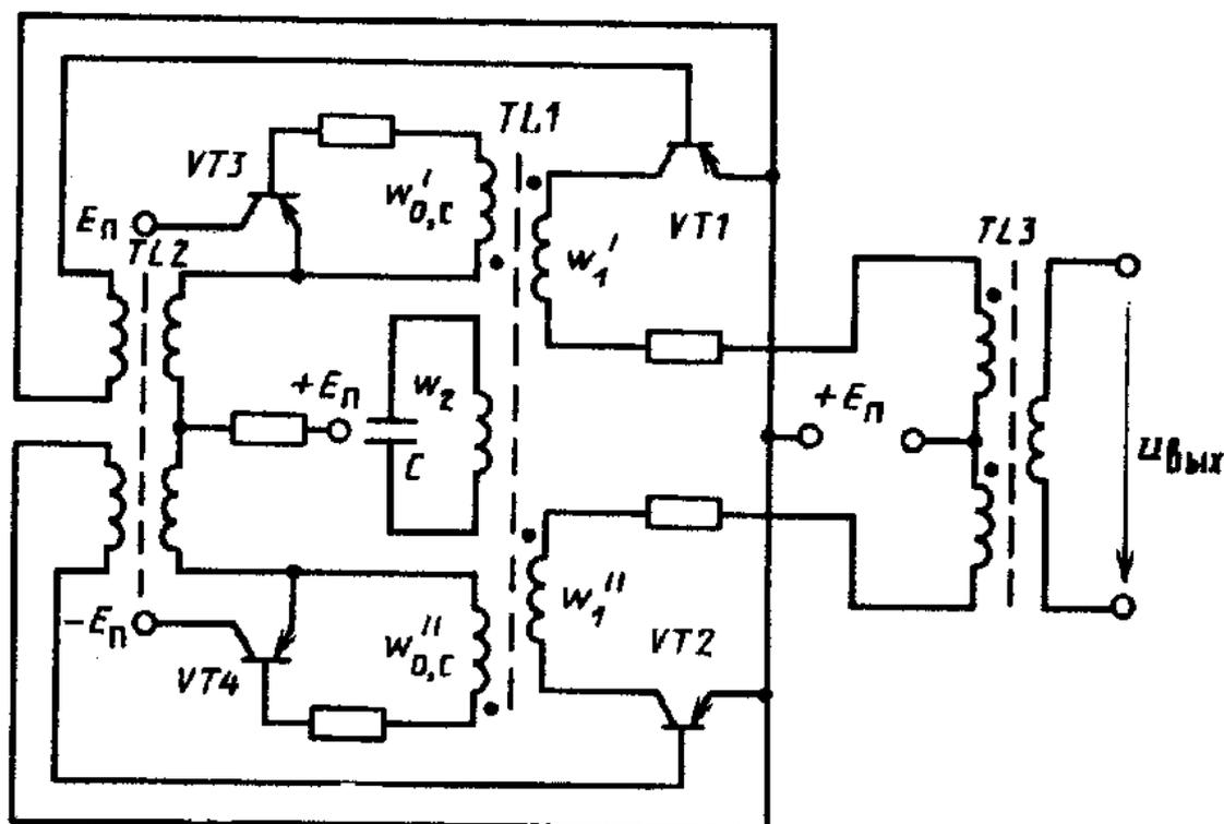
Рис. 11.2. Схема генератора синусоидального тока низкой частоты
