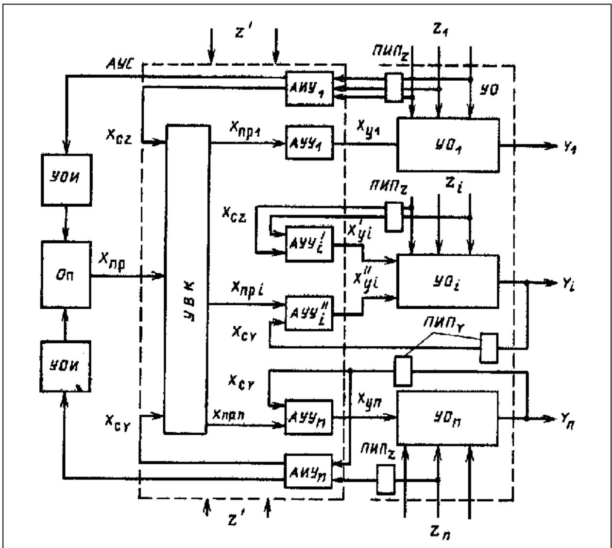
Рис 1.1. Структурная схема автоматической системы управления производством и распределением электроэнергии
