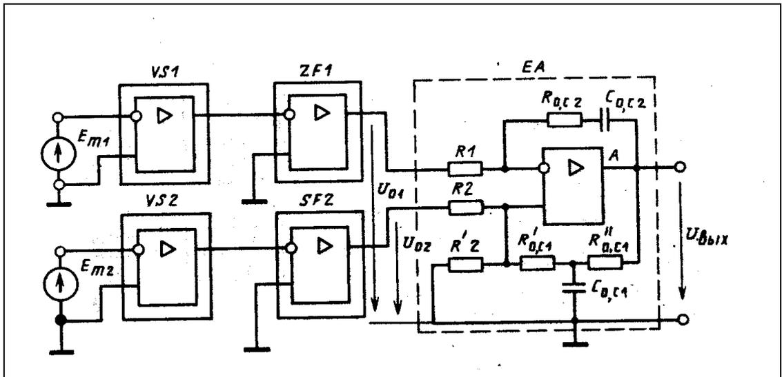
Рис. 8.8. Активный элемент сравнения амплитуд релейного действия
