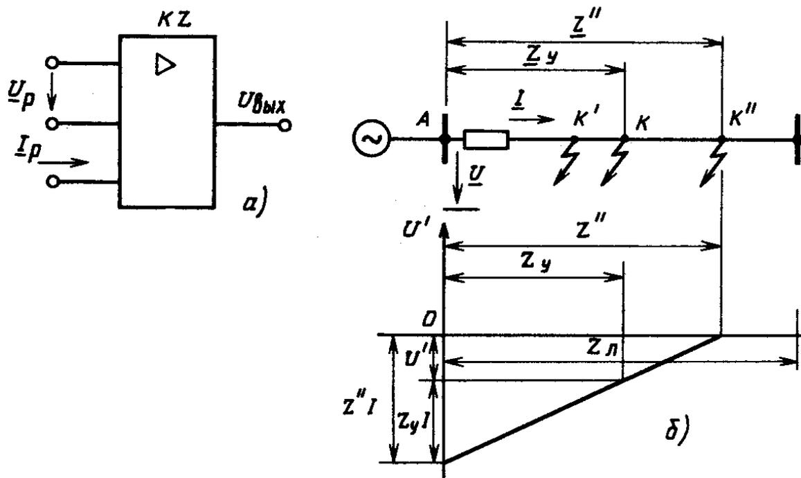
**Рис. 9.2.** Алгоритм (а), функциональная схема (б) измерительного органа полного сопротивления.
