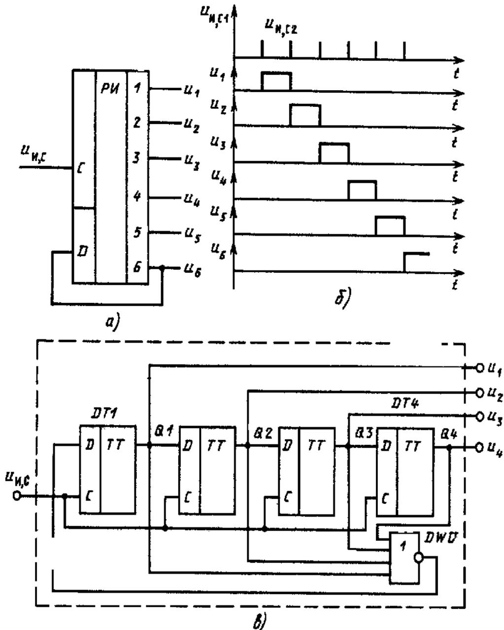
**Рис. 11.4.** Условное графическое обозначение (а), временная диаграмма действия (б) и функциональная схема (в) распределителя импульсов на триггерах
