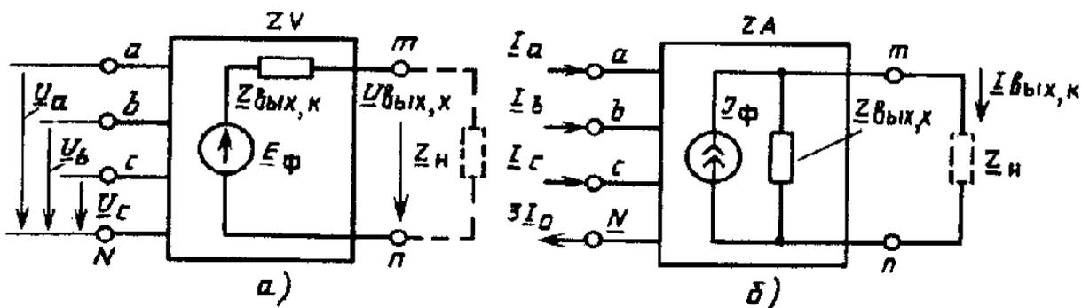
Рис. 6.1. Схемы включения фильтров симметричных составляющих напряжения (а) и тока (б)
