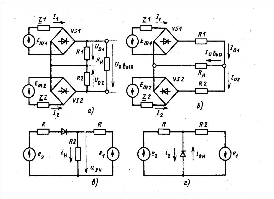
Рис. 8.4. Диодные элементы сравнения амплитуд (а, б) и схемы их замещения (в, г)
