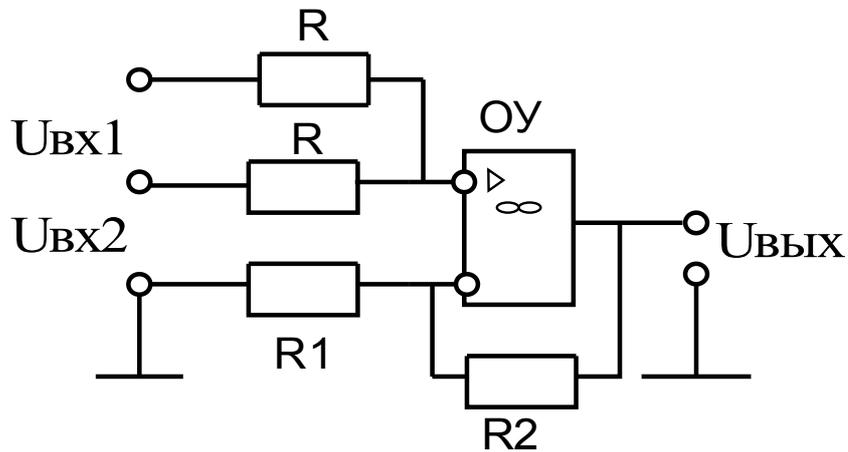
2. Построить  $U_{\text{ВЫХ}} = f(U_{\text{ВХ}})$ , при  $R_1 = 2 \text{ кОм}$ ,  $R_2 = 20 \text{ кОм}$ ,  $U_{\text{ВХ1}} = 20 \text{ мВ}$ ,  $U_{\text{ВХ2}} = 40 \text{ мВ}$ , шаг 5 мВ.
