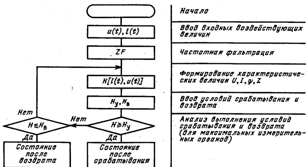
**Рис. 9.1.** Общий алгоритм функционирования измерительного органа релейного действия
