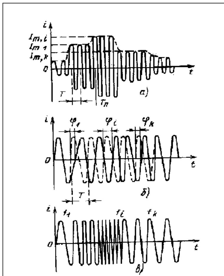
**Рис. 1.3.** Сигналы в виде изменений амплитуды (а), фазы (б) и частоты (в) синусоидального тока
