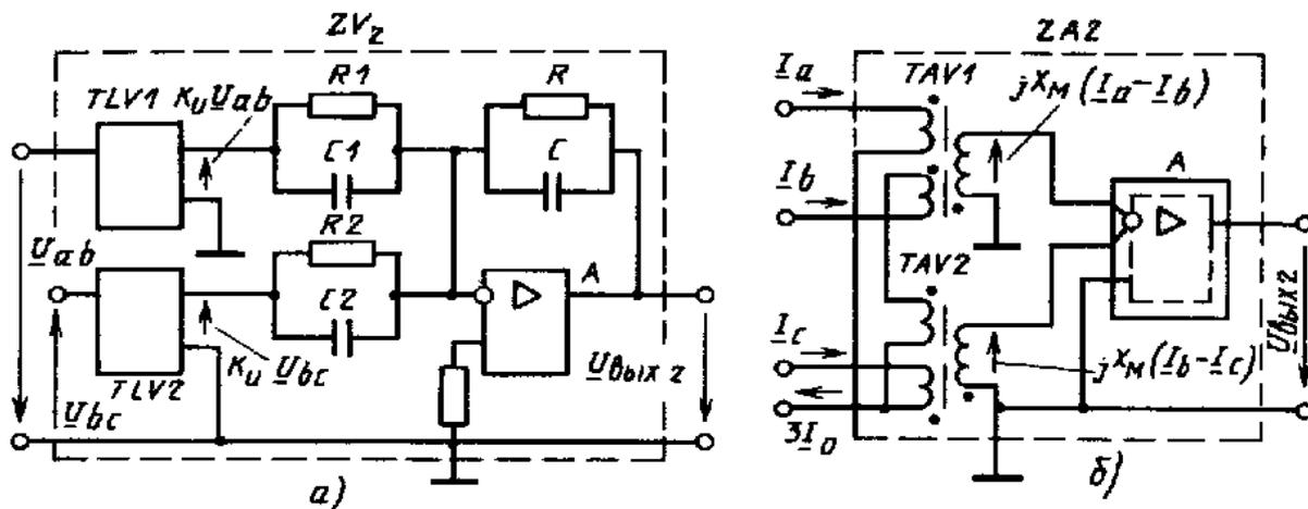
**Рис. 6.4.** Схемы активных фильтров обратной последовательности напряжения (а) и тока (б)
