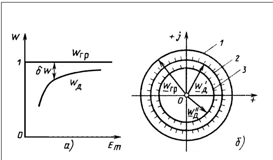
Рис. 8.2. Графики погрешностей (а) и характеристики действия (б) релейного элемента сравнения амплитуд
