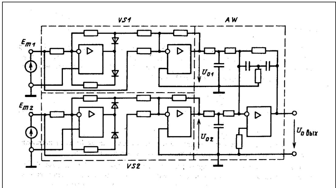
Рис. 8.7. Активный элемент сравнения амплитуд непрерывного действия
