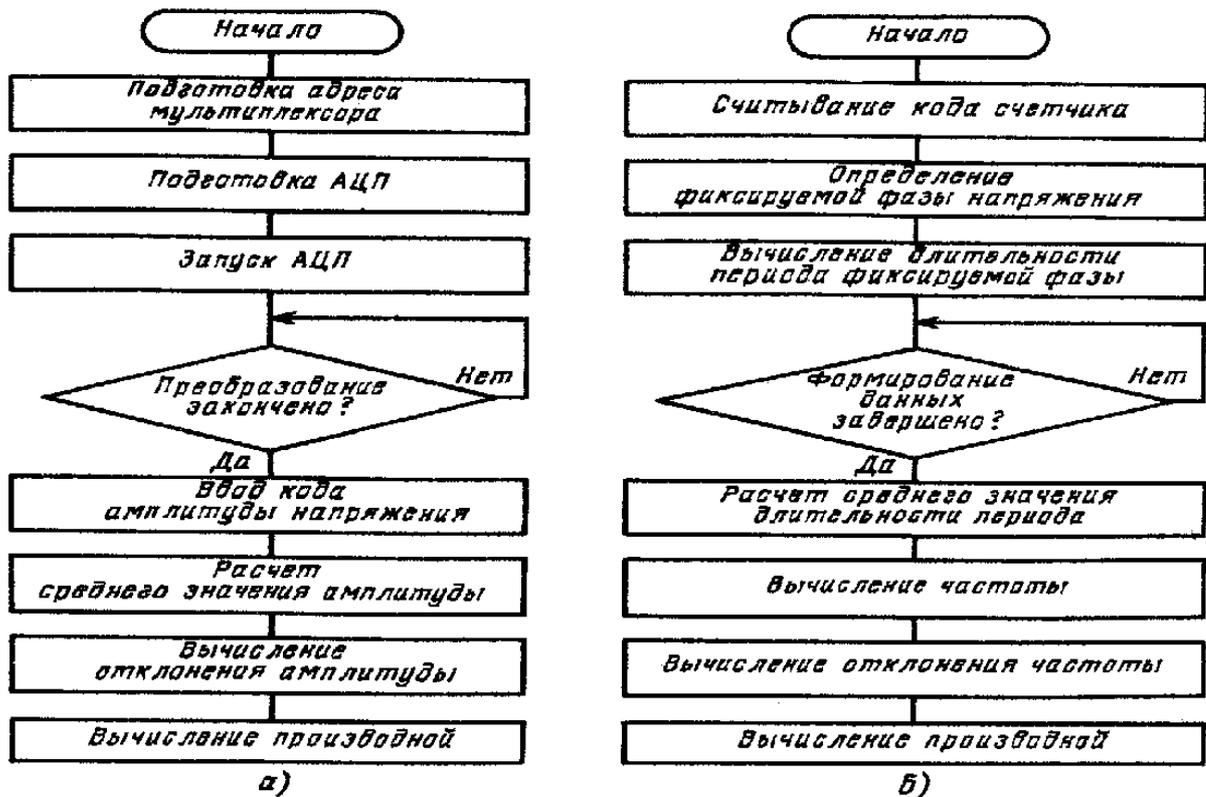
Рис. 9.4. Структурные схемы программ цифровых измерительных органов амплитуды (а) и частоты (б) напряжения
