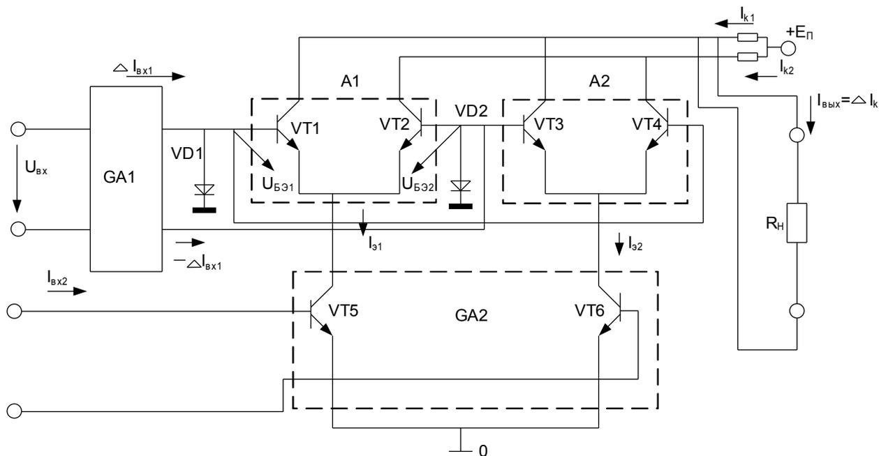
**Рис. 7.1.** Схема, поясняющая действие интегрального перемножителя с переменной крутизной характеристики
