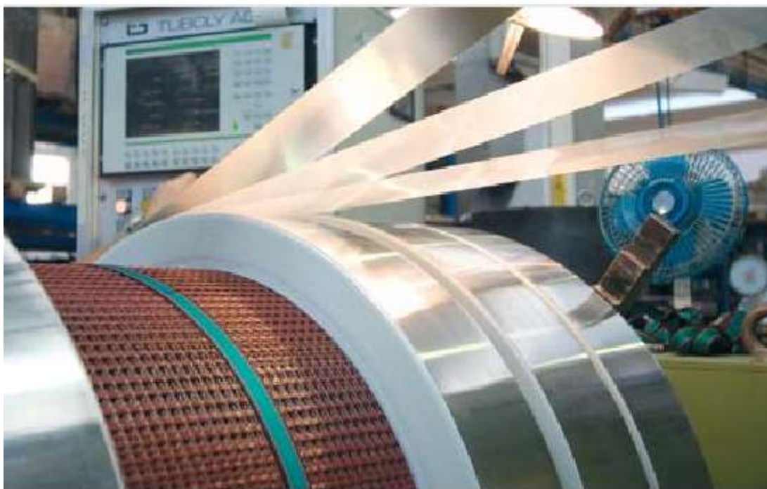
Рис. 3-19. Изготовление обмотки высокого напряжения
