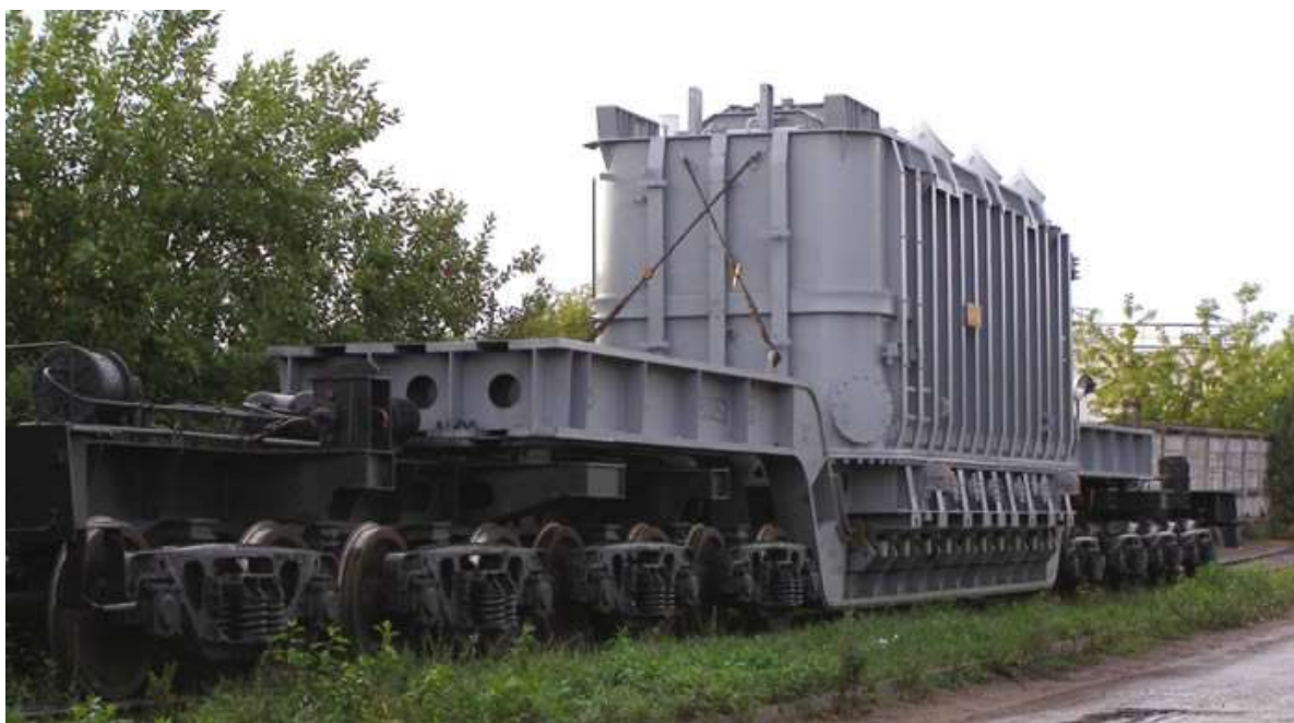
Рис. 3-4. Платформенный транспортёр [3-8]. Предназначен для перевозки тяжёловесных, длинномерных и крупногабаритных грузов. Оборудован металлическим полом с отверстиями для крепления груза.
