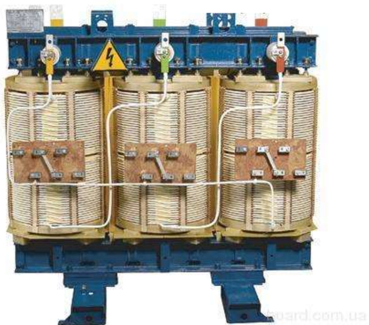
Рис. 3-14. Трансформатор силовой сухой серии ТС без защитного кожуха двухобмоточный, общего назначения. Выпускаются мощностью от 25 до 1600 кВА напряжением до 10 кВ.
