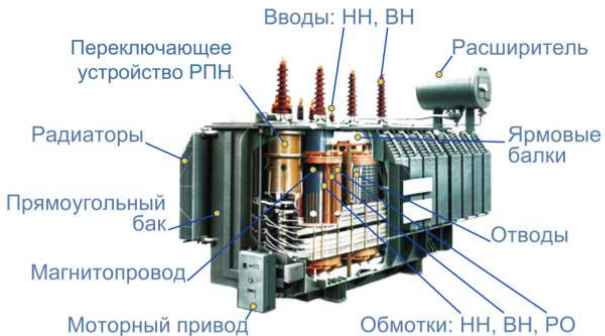
Рис. 3-1. Элементы конструкции силового трансформатора.
