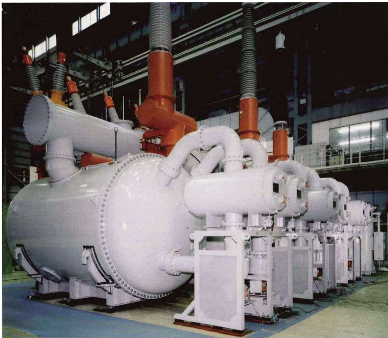
Рис. 3-24. Силовой трансформатор с элегазовой изоляцией фирмы Toshiba, 330 кВ, 400 МВА.
