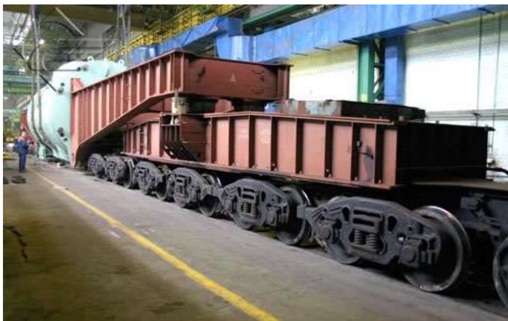
Рис. 3-6. Транспортёр сочлененного типа [3-8]. Предназначен для перевозки энергоблоков, турбогенераторов, трансформаторов и другого крупногабаритного оборудования массой до 500 тонн. Перевозимый груз подвешивается между половинами транспортера.
