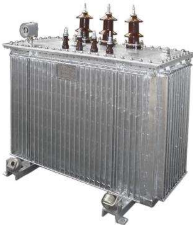
Рис. 3-17. Трансформаторы герметичные сухие в герметичном баке внешнего исполнения У1 серии ТСЗНГ с обмотками, изготовленными из проводов с изоляцией «NOMEX» класса нагревостойкости Н (180°С), двухобмоточные, общего назначения мощностью от 10 до 100 кВА напряжением до 10кВ.
