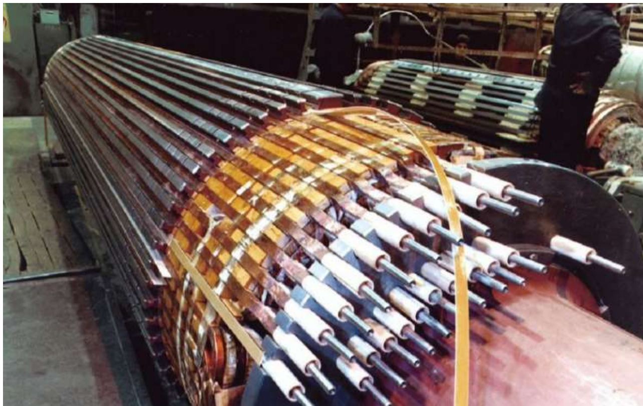
Рис. 2-7. Выводы обмотки ротора турбогенератора ТЗВ: нижний ряд - напорные выводы, верхний ряд - сливные [2-9].
