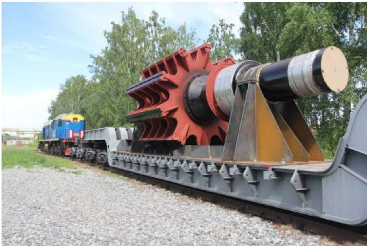
Рис. 2-15. Перевозка по железной дороге вала ротора гидрогенератора с насаженной на вал втулкой. Масса груза 138 т, длина – 11 м. Из-за размеров этот груз – негабаритный .
