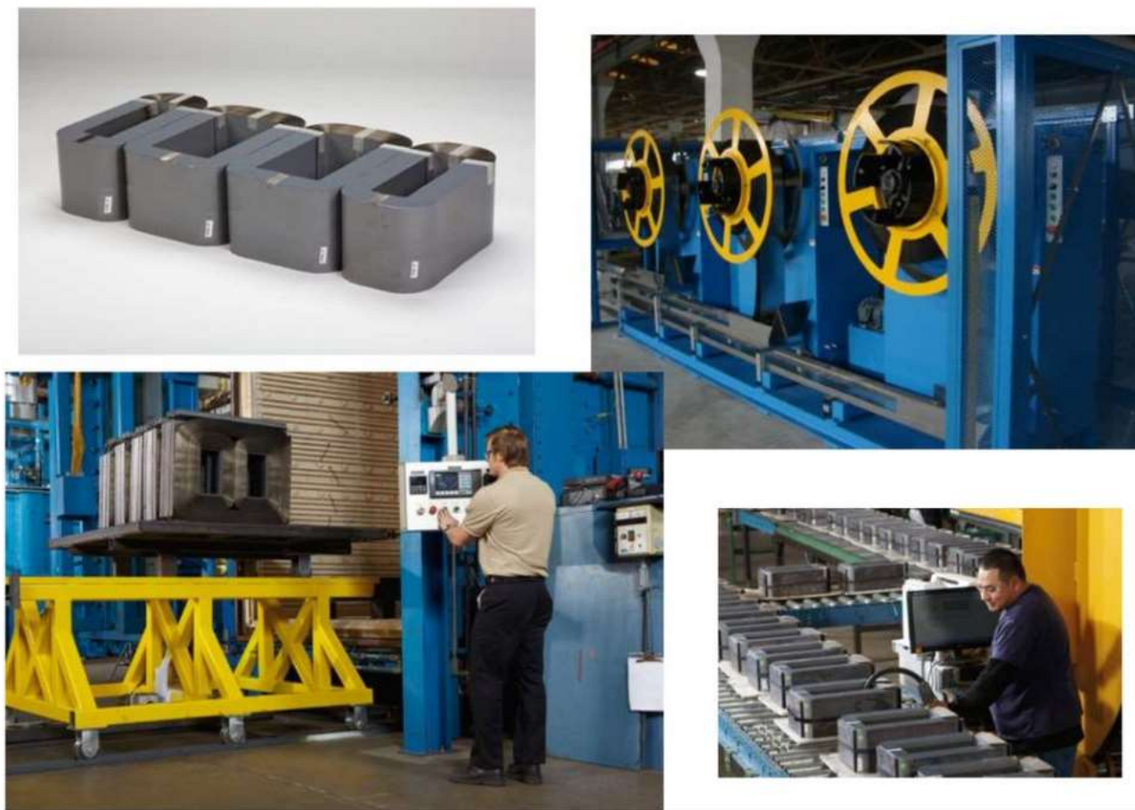
Рис. 3-27. Технологические линии по производству сердечников трансформаторов из аморфной стали.
