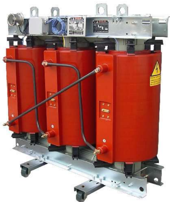
Рис. 3-15. Трансформатор силовой сухой серии ТС без защитного кожуха двухобмоточный, общего назначения. Выпускаются мощностью от 25 до 1600 кВА напряжением до 10 кВ.
