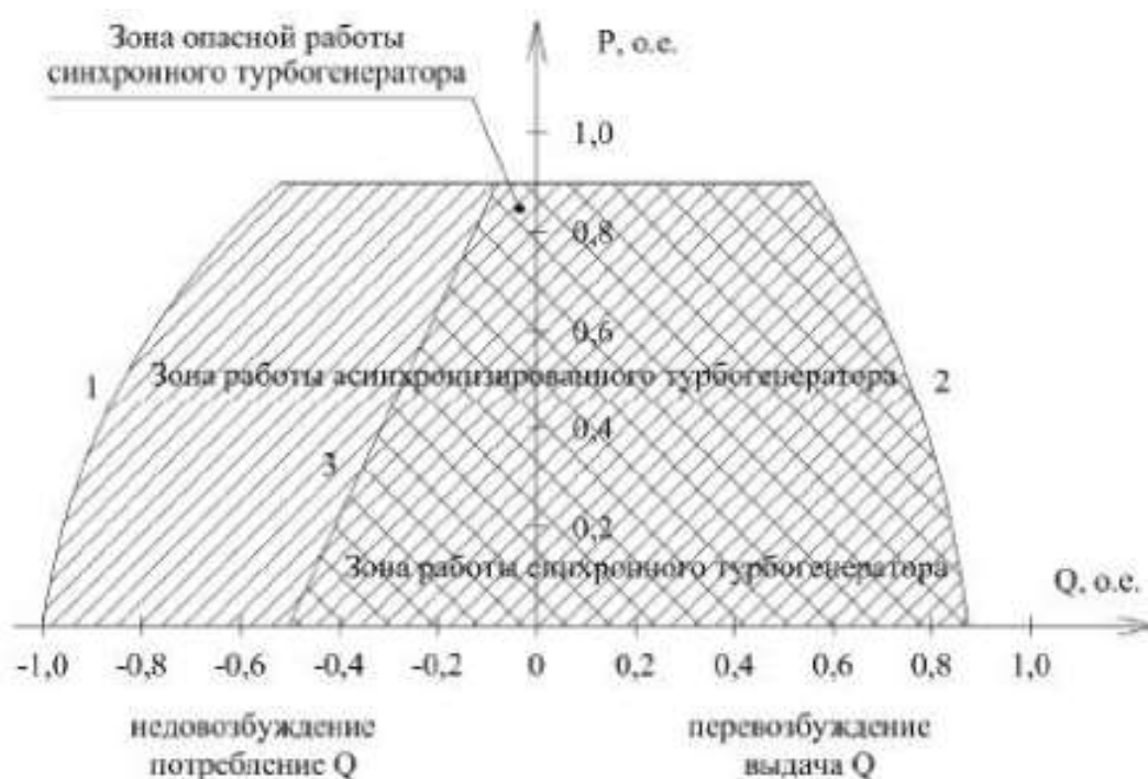
Рис. 2-11. Области допустимых режимов работы синхронных и асинхронизированных турбогенераторов по активной и реактивной мощности: 1 – ограничения по номинальному току статора; 2 – ограничения по номинальному току возбуждения; 3 – ограничения минимального возбуждения синхронного генератора по условиям устойчивости [2-11].
