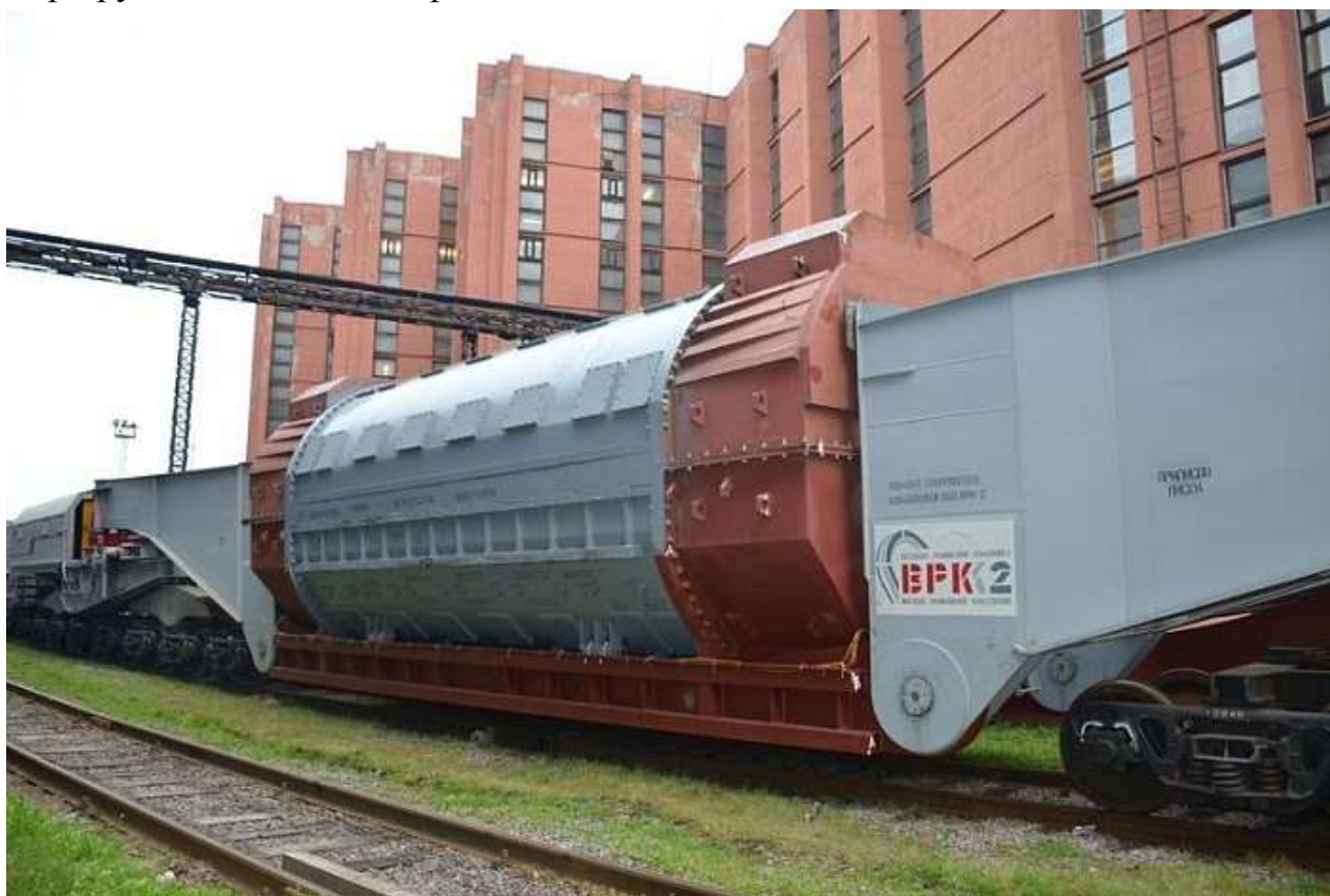
Рис. 2-2. Перевозка по железной дороге статора генератора АЭС на 32-осном транспортёре грузоподъёмностью 500 тонн. Масса груза с учетом довольно тяжелой транспортной оснастки 470 – 480 т. Из-за размеров этот груз – сверхнегабаритный .
