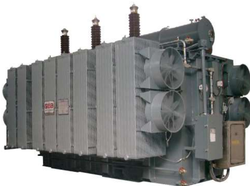
Рис. 3-9. Трансформатор с естественной циркуляцией масла и принудительным воздушным охлаждением дутьевыми вентиляторами.
