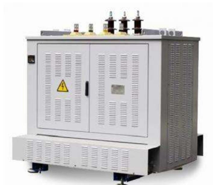
Рис. 3-16, а. Трансформаторы силовые сухие серии ТС(З)НО с принудительным охлаждением (автоматическое включение вентиляторов для повышения номинальной мощности трансформатора до 40%) с обмотками, изготовленными из проводов с изоляцией «NOMEX» класса нагревостойкости Н (180°С), двухобмоточные, общего назначения мощностью от 400 до 1600 кВА напряжением до 10 кВ.
