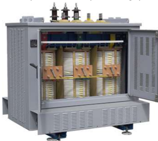
Рис. 3-16, а. Трансформаторы силовые сухие серии ТС(З)НО с принудительным охлаждением (автоматическое включение вентиляторов для повышения номинальной мощности трансформатора до 40%) с обмотками, изготовленными из проводов с изоляцией «NOMEX» класса нагревостойкости Н (180°С), двухобмоточные, общего назначения мощностью от 400 до 1600 кВА напряжением до 10 кВ.
