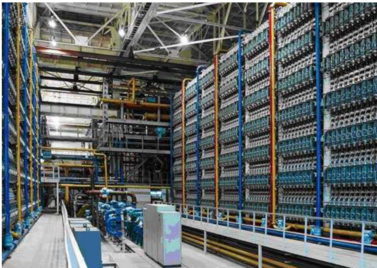
Рис. 2-8. Центрифуги на предприятии по обогащению урана.
