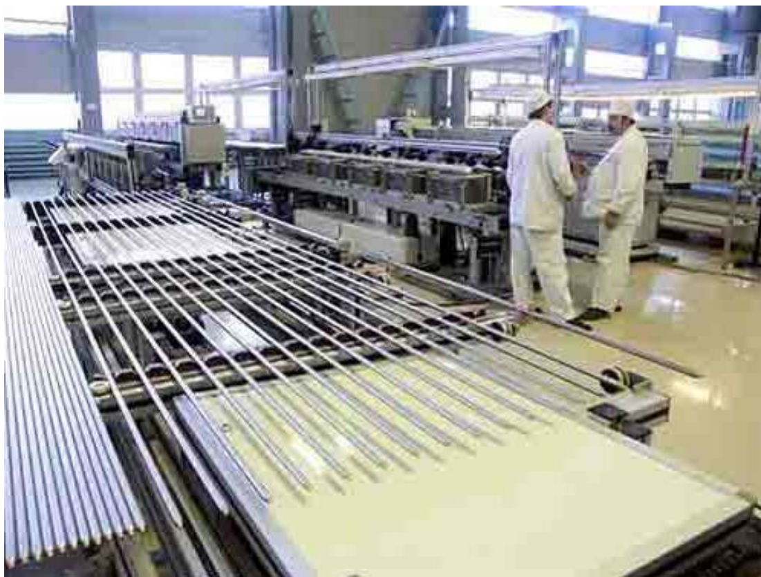
Рис. 2-10. Производство оболочек ТВЭЛов.
