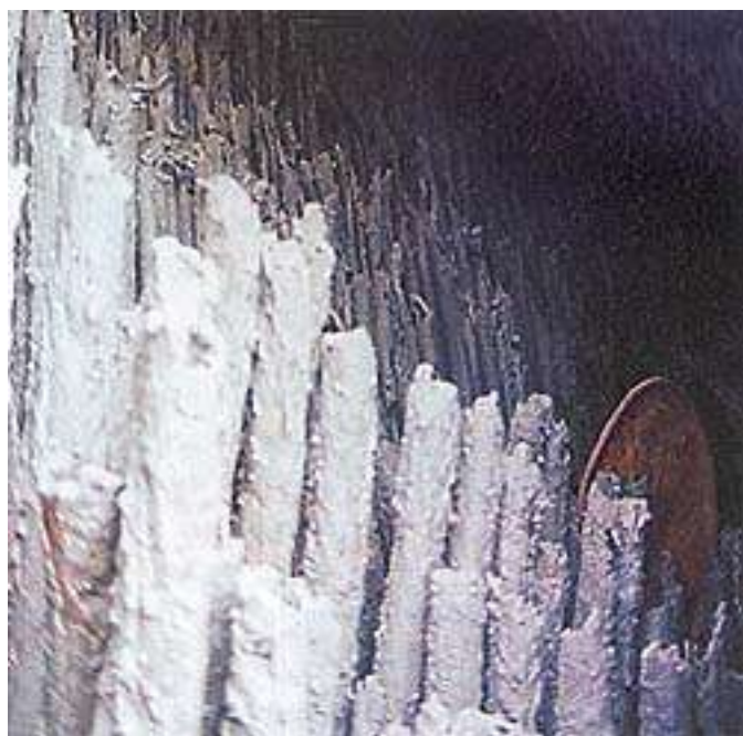
Рис. 3.11. Расплавление труб котла в результате перегрева при недостатке воды [3-5].
