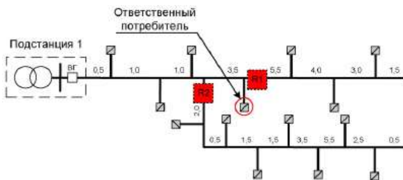
Рис. 5-5. Установка реклоузеров для повышения надежности ответственного потребителя на радиальном фидере [5-4].
