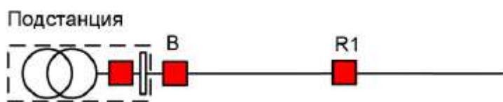
Рис 5-3. Установка реклоузеров для повышения надежности радиального фидера: В – головной выключатель на подстанции; R1 – реклоузер [5-4].
