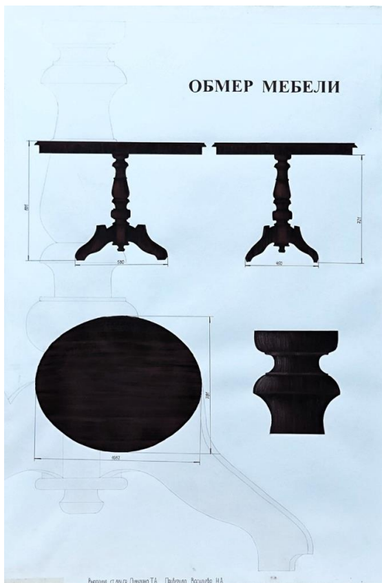
Рис. 14. Примеры подачи обмерных чертежей стола на планшете 50X75
