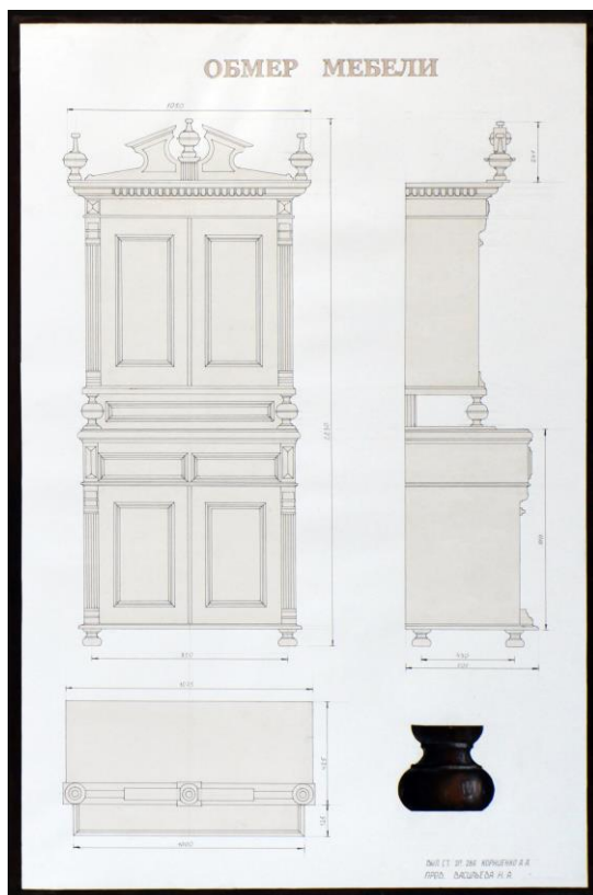
Рис. 13. Примеры подачи обмерных чертежей шкафа на планшете 50X75
