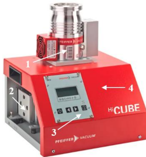
Рис. 15. Фотография откачного поста PFEIFFER VACUUM Hi CUBE, в состав которого входят следующие компоненты: 1 – высоковакуумный турбомолекулярный насос HiPace 80; 2 – безмасляный форвакуумный мембранный насос MPV 015-02; 3 – система управления и электропитания; 4 – корпус.
