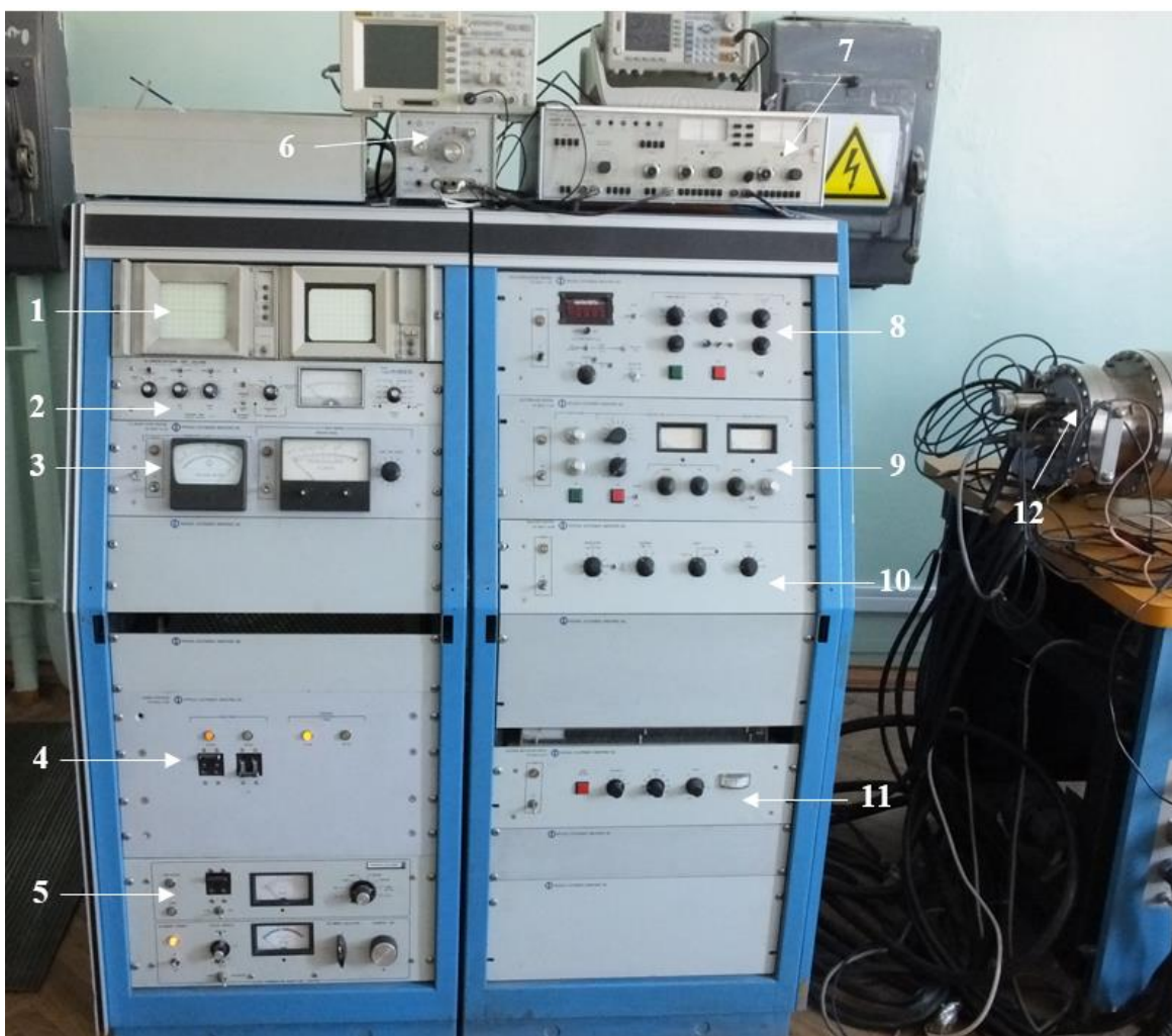
Рис. 25. В состав прибора PHI-590 входят: 1 – мониторы на основе электронно-лучевой трубки (MONITOR TEKTRONIX); 2 – прибор для измерения давления в СВВ камере (GAUGE CONTROLLER Model JBA12AS); 3 – прибор контроля дегазации СВВ камеры (T.C. GAUGE/OVEN CONTROL PHI Model 20-105); 4 – источник питания (POWER INTERLOCK PHI Model 18-030); 5 – блок питания и управления ионным насосом (PE BOOSTIVAC CONTROL); 6 – задающий генератор; 7 – усилитель оже-сигнала (LOCK-IN ANALYZER Model 5204); 8 – системный контроллер ЭОС/СХПЭЭ, определяющий скорость развертки (ESCA/AUGER SYSTEM CONTROL PHI Model 11-055); 9 – контроллер электронной пушки (ELECTRON GUN CONTROL PHI Model 11-010); 10 – контроллер модуляции (ANALYZER CONTROL PHI Model 20-805); 11 – электронный умножитель (ELECTRON MULTIPLIER SUPPLY PHI Model 20-075); 12 - СВВ камера с АЦЗ.
