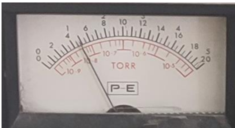
Рис. 13. Шкала прибора для измерения давления в ионном насосе и в СВВ камере при откачке
