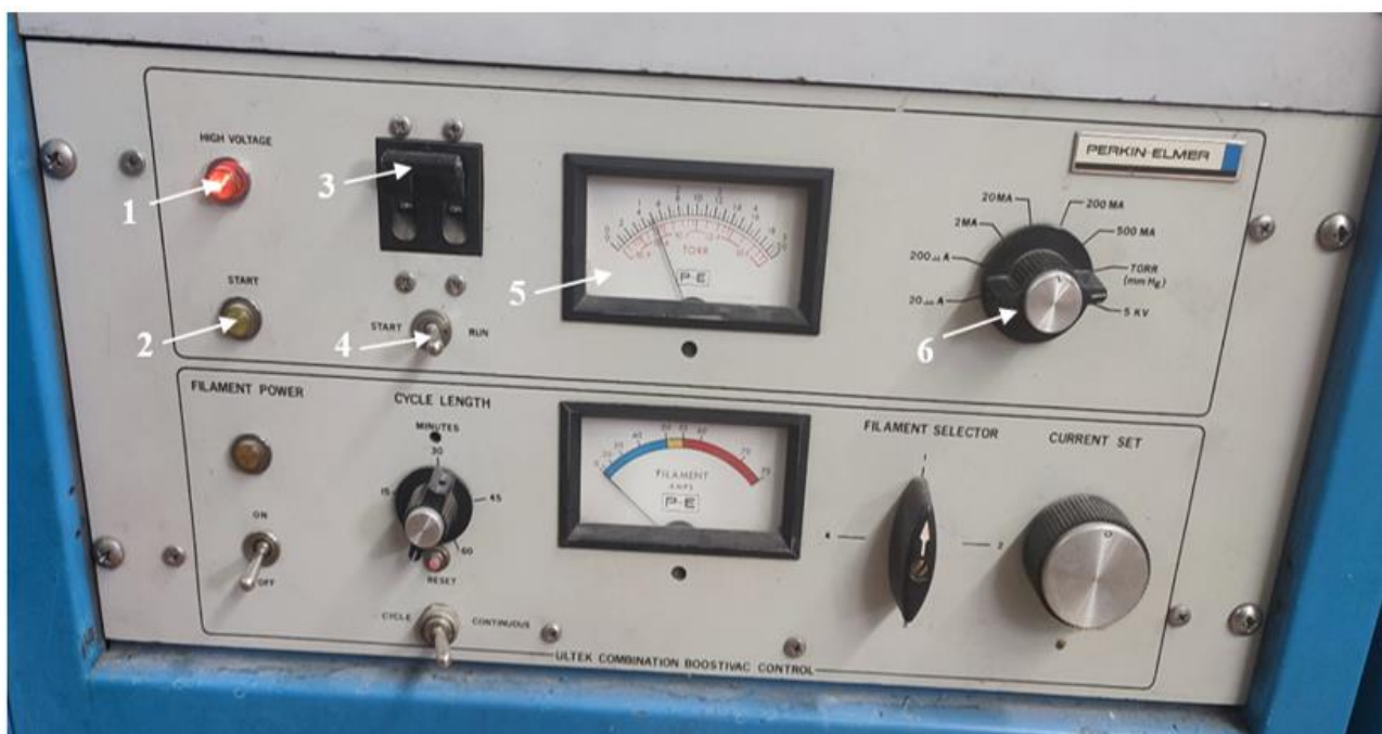
Рис. 19. Блок питания и управления ионным насосом: 1 и 2 – световые индикаторы напряжения питания сети (HIGH VOLTAGE) и режима запуска ионного насоса (START) соответственно; 3 – автомат отключения насоса; 4 – переключатель режимов работы насоса (START/RUN); 5 – стрелочный индикатор давления, тока и напряжения; 6 – галетный переключатель режимов измерения и отображения рабочих характеристик ионного насоса
