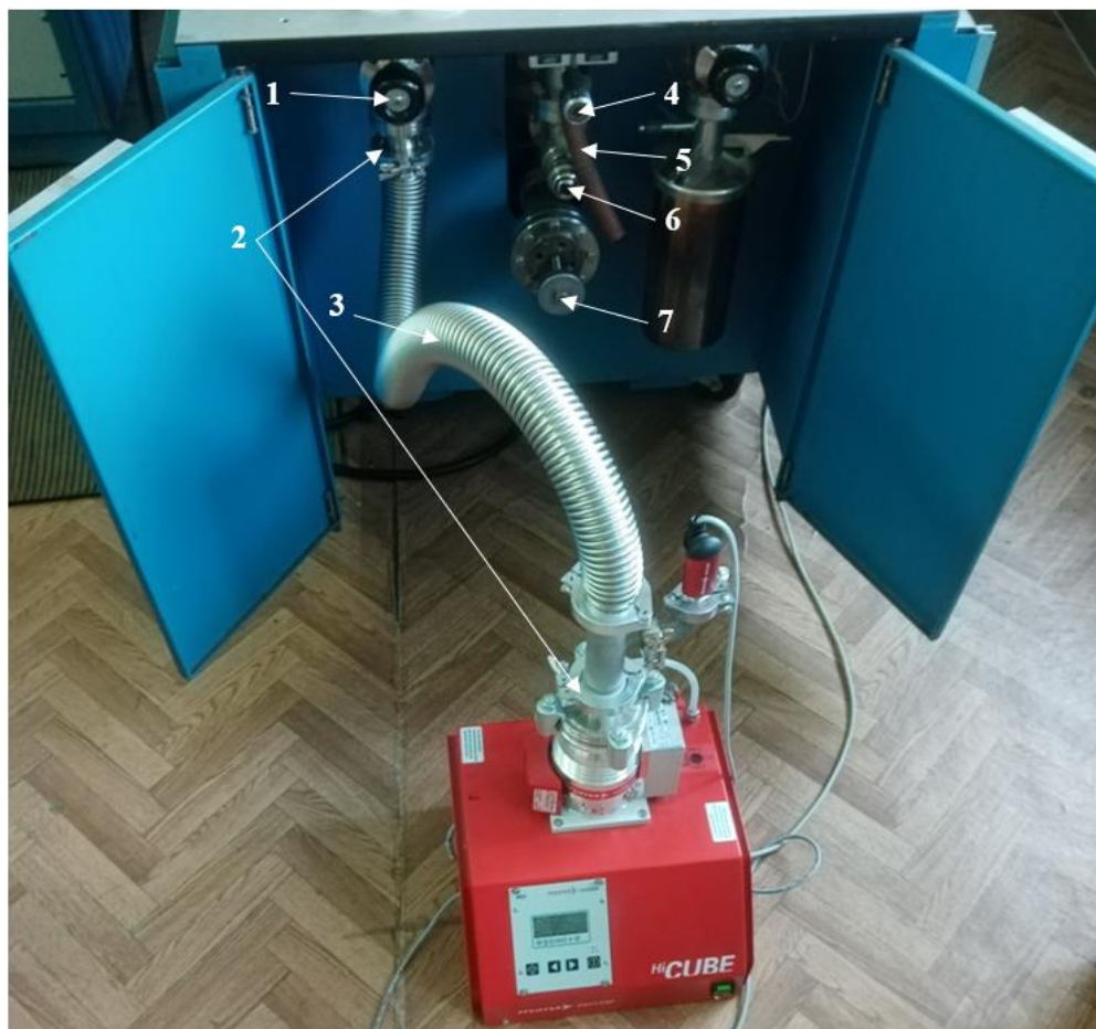
Рис. 21. Откачная система и вентили: 1 – клапан откачного поста; 2 – фланцы ISO-KF; 3 – гофра; 4 – малый клапан напуска; 5 – патрубков напуска; 6 – клапан СВВ камеры; 7 – клапан ионного насоса.
