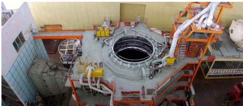
Рисунок 2.10 – Стендовое изделие в термобарокамере для тепловакуумных испытаний
