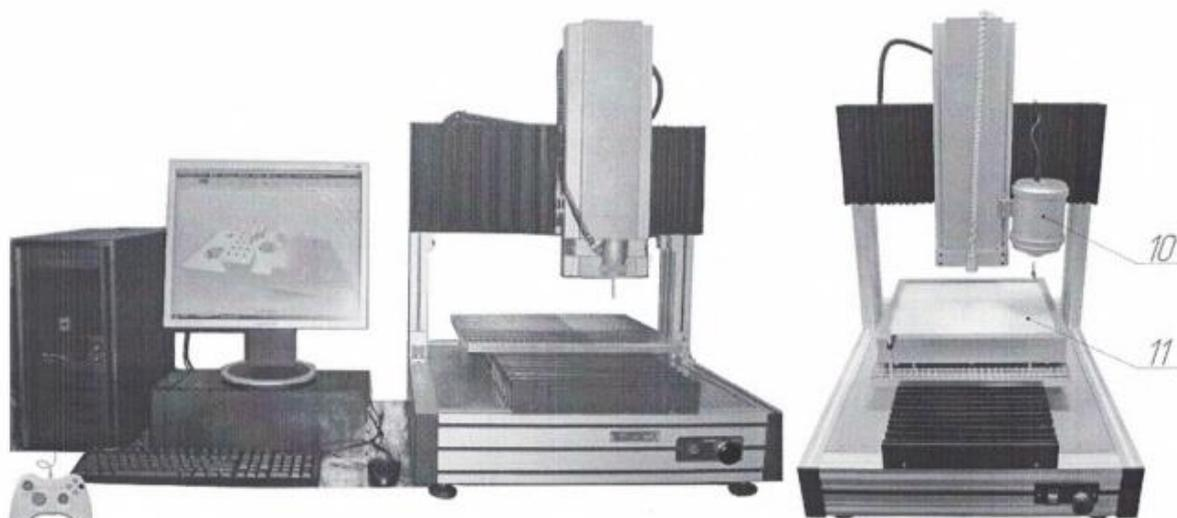
10 Оптический узел (цифровая видеокамера)
