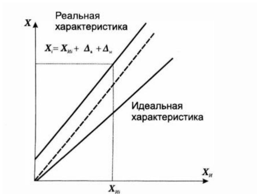
Рисунок 6.3 – Графическое изображение систематической погрешности
