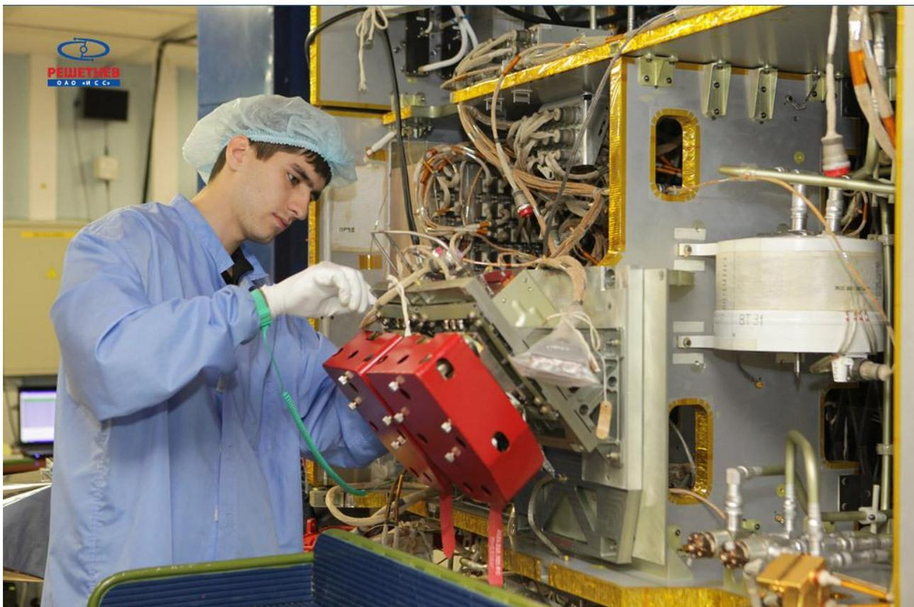
Рисунок 5.6 – Электрические испытания спутника
