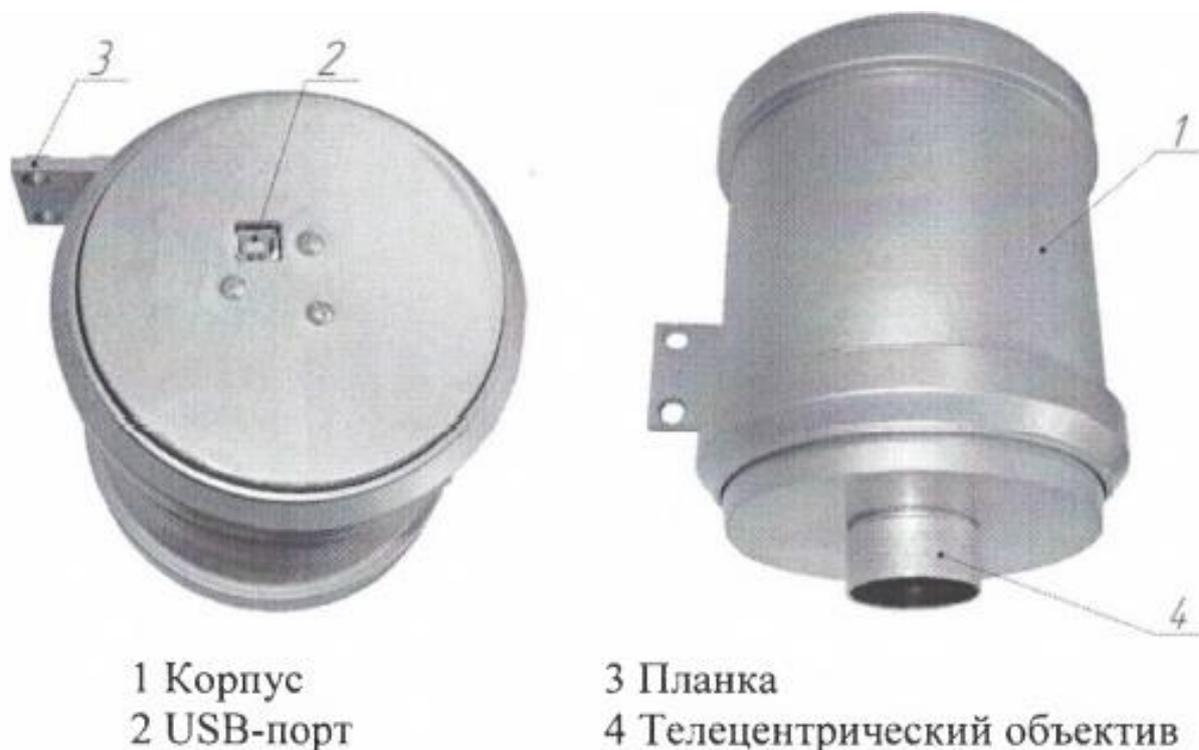
Рисунок 10.10 – Общий вид оптического узла
