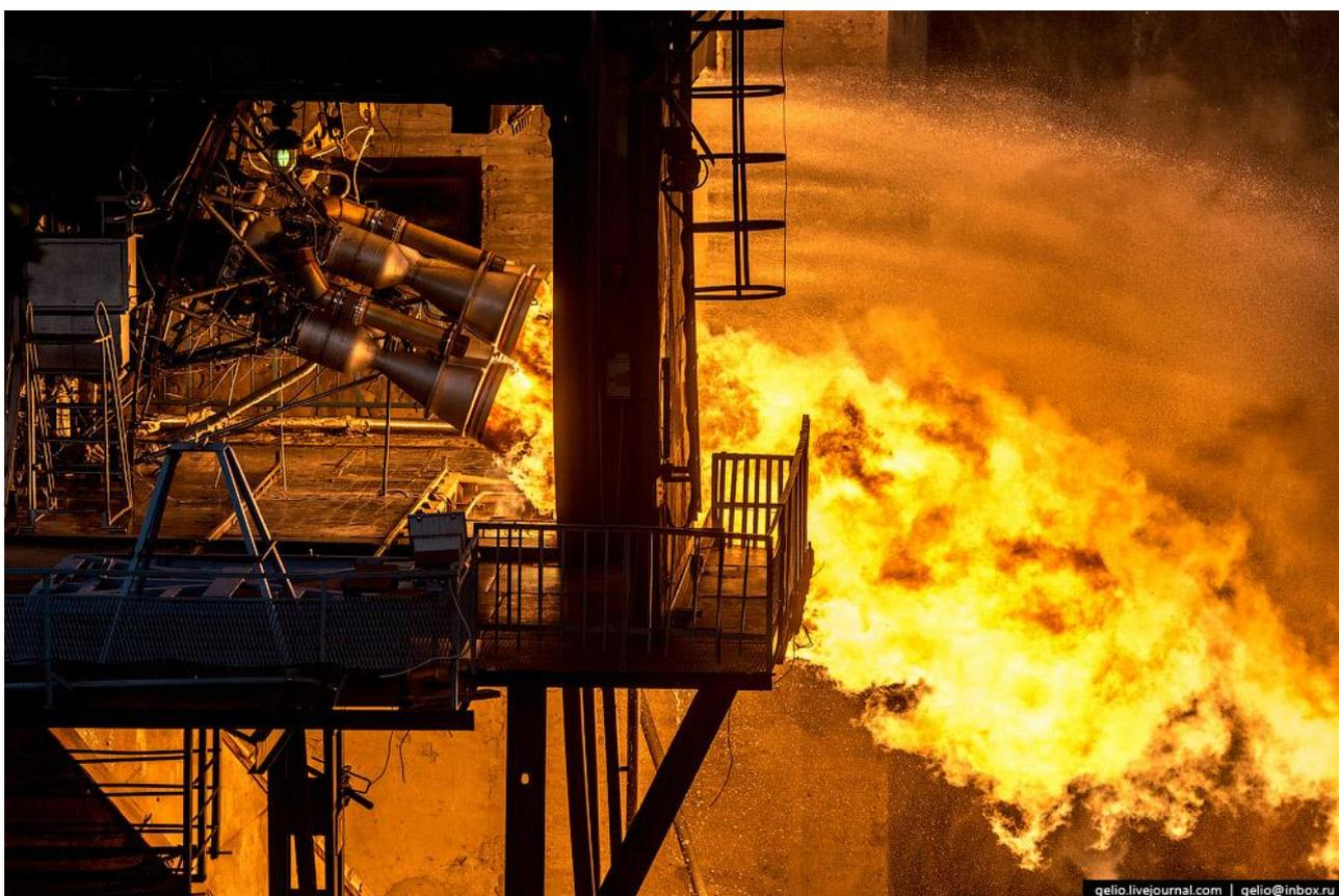
Рисунок 8.39 – Стенд для «огневых» испытаний ПГС ДУ
