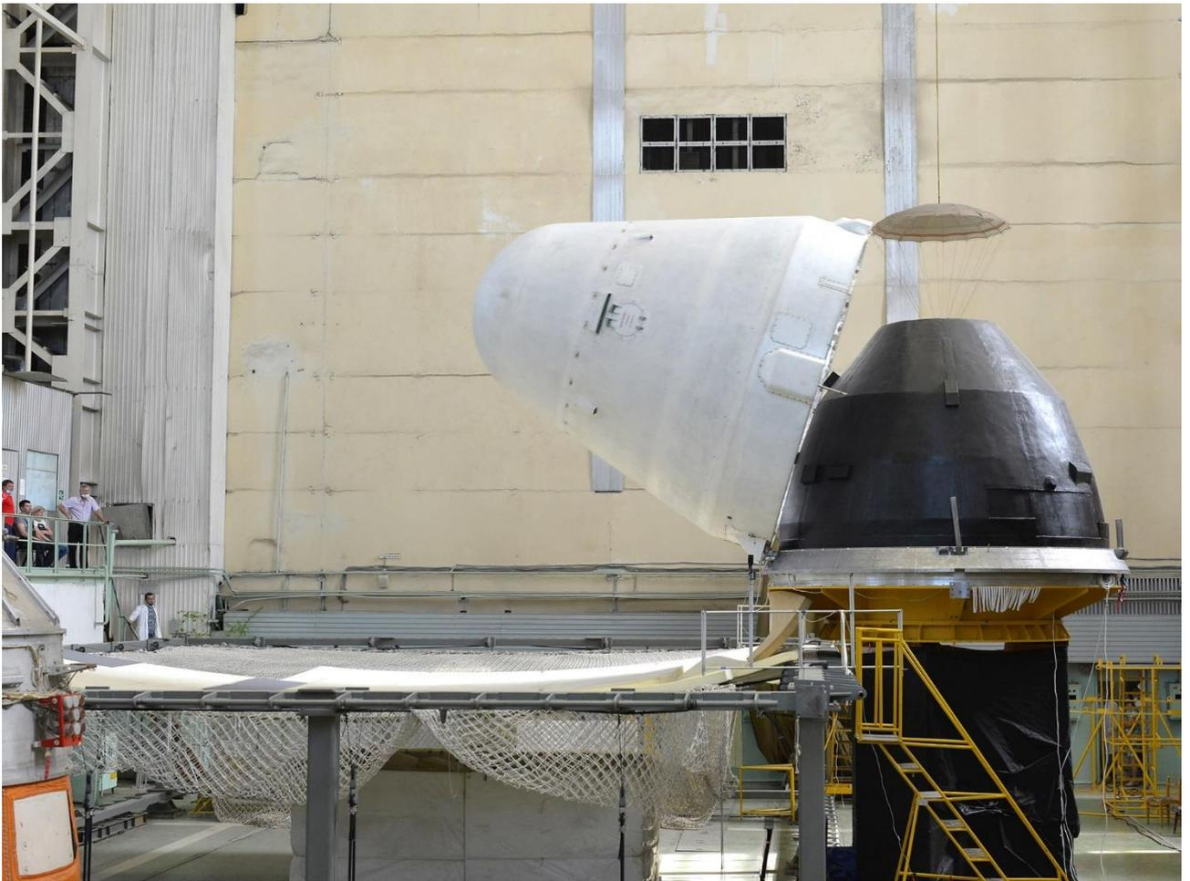
Рисунок 5.4 – Испытания средств разделения
