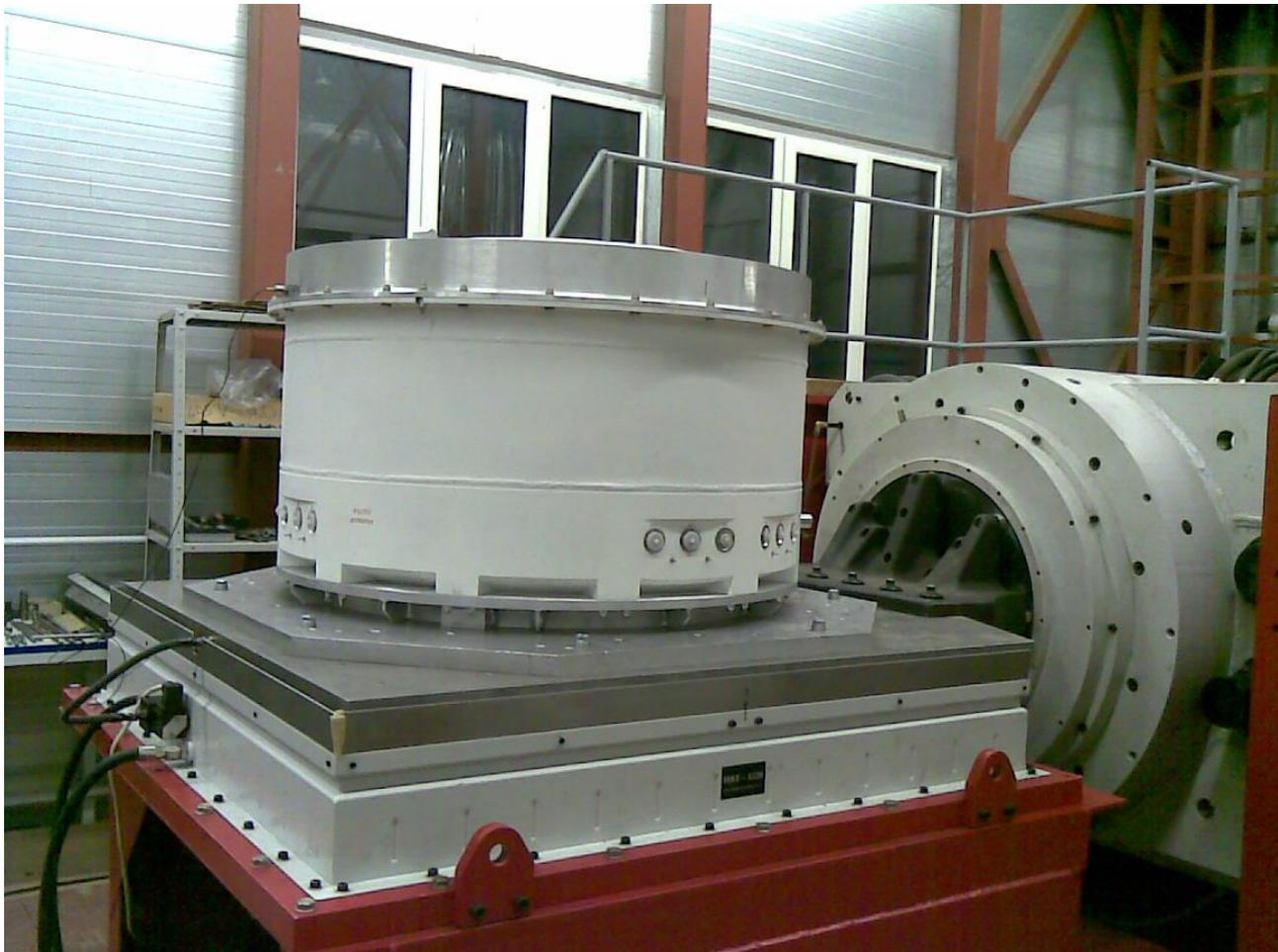
Рисунок 5.2 – Изделие на вибростенде
