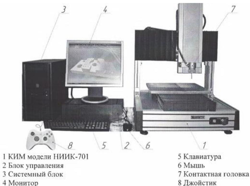
Рисунок 10.1 – Общий вид учебного лабораторного комплекса КИМ с ЧПУ НИИК-701 (базовый вариант)
