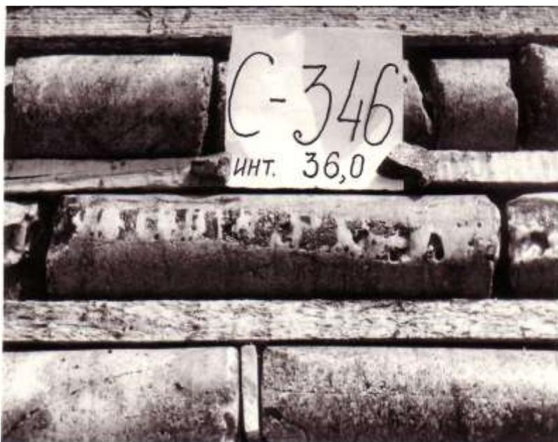
При документации керна необходимо произвести укладку керна т.е. произвести ориентировку отдельных кусков относительно оси скважины, по направлению слоистости и другим текстурным и структурным элементам. Обычная зарисовка по разрезу буровых скважин составляется в масштабе 1:100 – 1:500, а важные детали керна в масштабах 1:5 – 1:20. Зарисовка выполняется в виде проекции на плоскость сечения, проходящего вдоль оси скважины.
