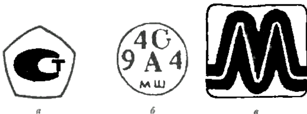
Рис. 9. Знаки в метрологии: а - знак утверждения типа СИ; б — поверительное клеймо; в — знак системы добровольной сертификации СИ.
