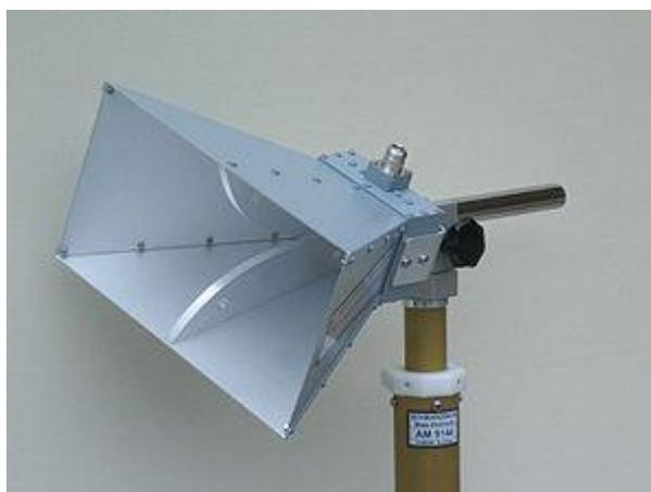
Рисунок 12.4 – Широкополосная измерительная рупорная антенна на частоты (0,8–18) ГГц
