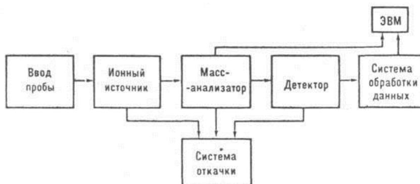
Рисунок 5.9 - Структурная схема масс-спектрометра
