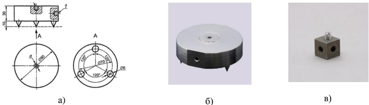
1 – резьбовое соединение для крепления акселерометра или кубика под акселерометр
