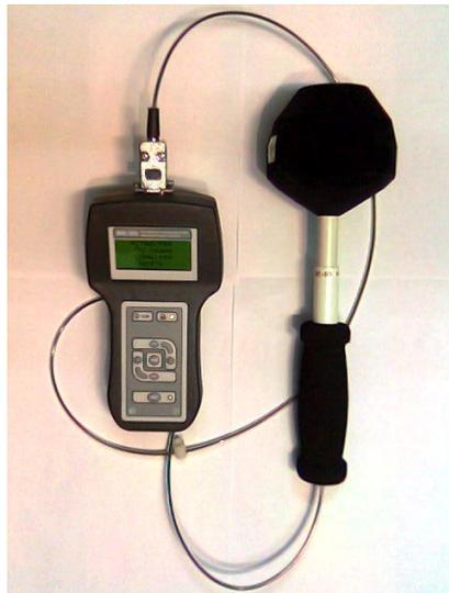
Рисунок 12.6 - Внешний вид Измерителя «BE-50»
