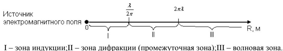
Рисунок 12.2 – Зоны излучения электромагнитного поля в зависимости от расстояния от источника излучения ( $\lambda$  – длина волны источника излучения)
