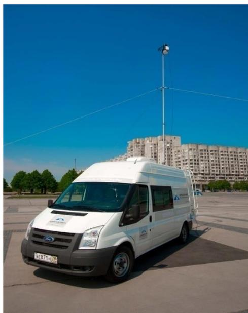
Рисунок 1.6 - Передвижная лаборатория контроля качества атмосферного воздуха (ПЛ-А) на шасси Ford Transzit
