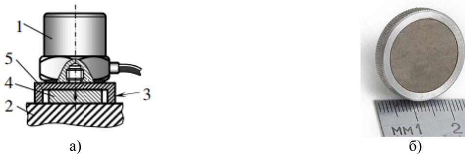
1 – акселерометр; 2 – контролируемый объект; 3 – магнитный держатель; 4 – постоянный магнит; 5 - магнитопровод
