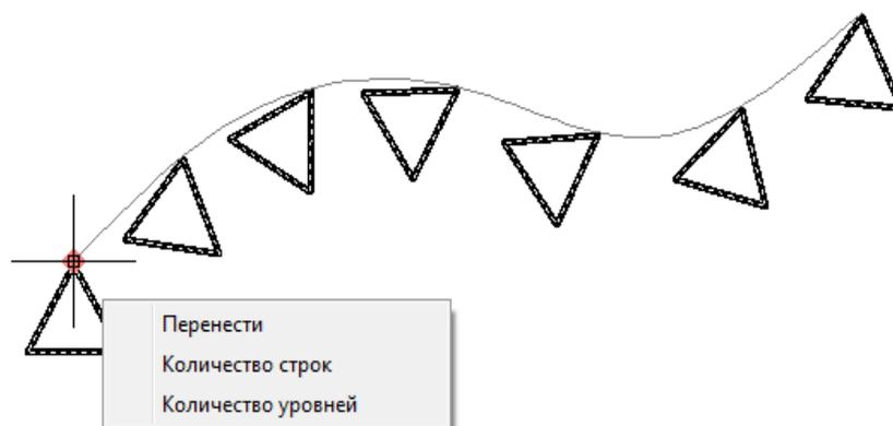
Рис. 1.38. Функции ручек массива по траектории.
