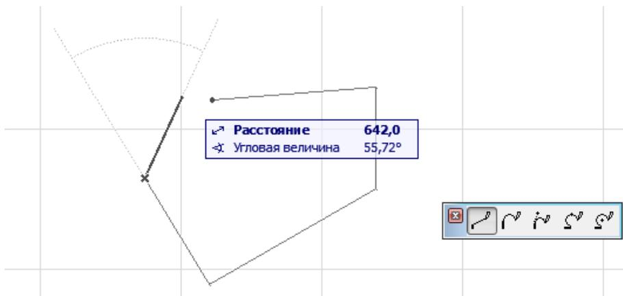
Рис. 42. Построение перекрытия в виде произвольного многоугольника.
