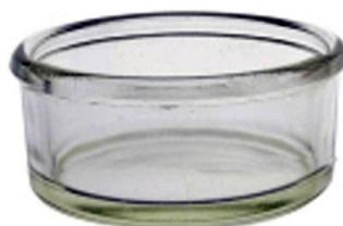
Рис. 7. Кристаллизатор.
