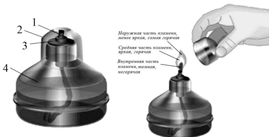
Рис. 17. Устройство спиртовки. 1 – фитиль, 2 – колпачок, 3 – трубка с диском, 4 – резервуар.
