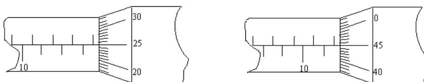
Рисунок 7 - отсчетное устройство микрометра:
