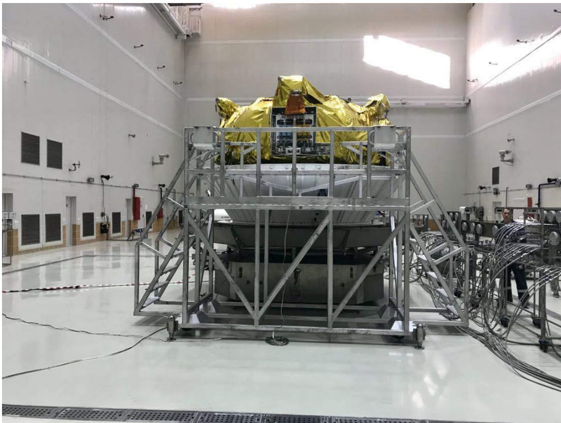
Рисунок 4 — Заправка разгонного блока «Фрегат» с помощью сборочных коммуникаций.
