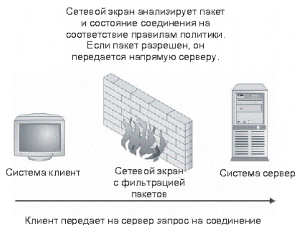
Рис. 2. Передача трафика через межсетевой экран с фильтрацией пакетов
