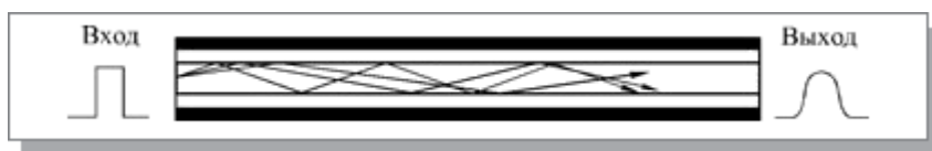
Рис. 6. Распространение света в многомодовом кабеле
