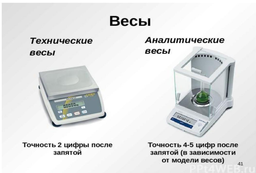
**Рис. 2.1.** Лабораторные электронные весы
