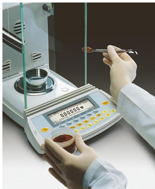
**Рис. 2.2.** Взвешивание на аналитических весах
