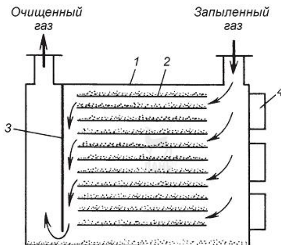
Рисунок 4.3 Принципиальная схема пылесадительной камеры:
