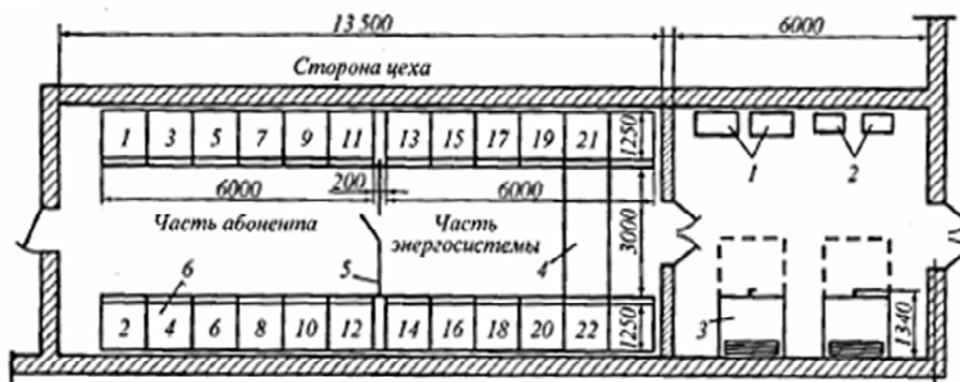
а) Расположение оборудования распределительной подстанции напряжением 10 кВ при двухрядном расположении камер КСО при разделении распределительной подстанции на части абонента и энергосистемы: 1 - блоки питания; 2 - щитки защиты; 3 - шкаф оперативного тока типа ШУОТ; 4 - мост шинный длиной 3000 мм; 5 - ограждение сегчатое с дверью; 6 - камера типа КСО-272
