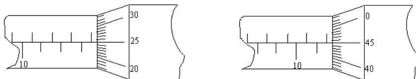
Рисунок 7 - отсчетное устройство микрометра: а) отсчет 13,5 + 0,25 = 13,75 ; б) отсчет 12,5 + 0,45 = 12,95 .
