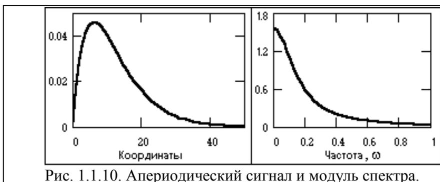
Рис. 1.1.10. Аperiodический сигнал и модуль спектра.
