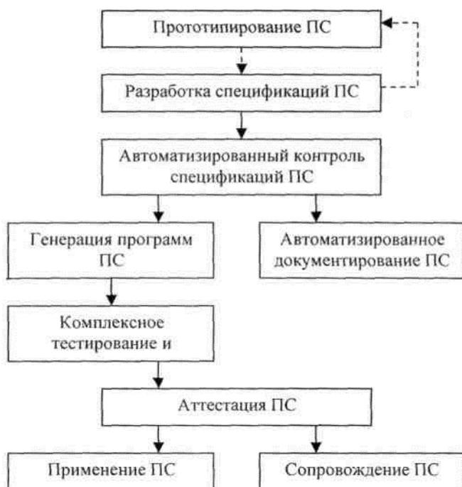
Рис. 16.3. Жизненный цикл программного средства для компьютерной технологии.
