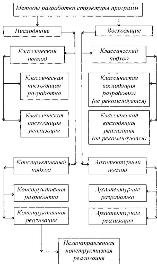
Рис. 7.3. Классификация методов разработки структуры программ.
