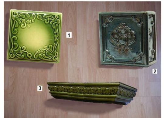
Изразцы для разных частей печи. 1. плоский (стенной) изразец 2. угловой изразец 3. Карнизный изразец.
