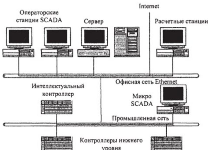
Рисунок 1.4 Обобщенная схема системы контроля и управления технологическими процессами
