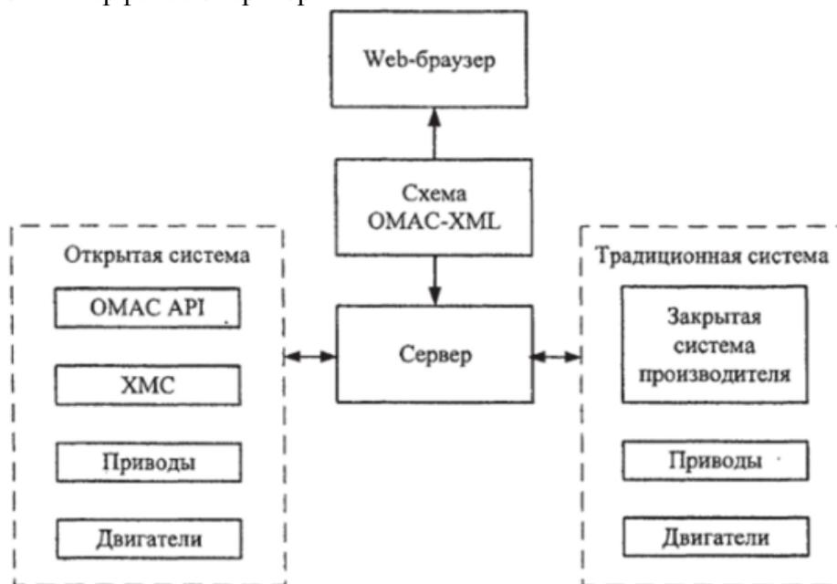
Рисунок 3.7. Структура Web-доступа к системам с ЧПУ
