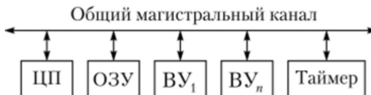
Рисунок 6.1. Функциональная схема соединения компонентов в ЭВМ на основе общего магистрального канала
