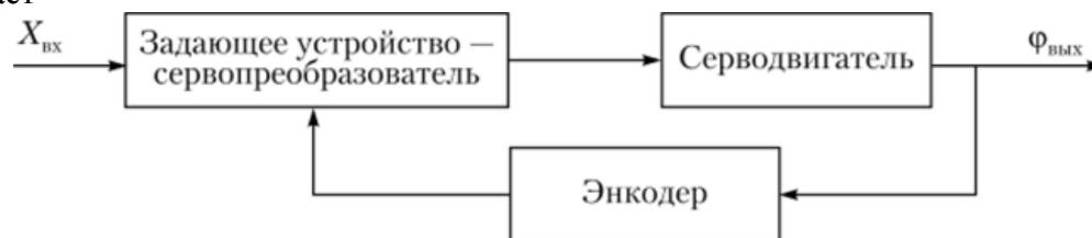
Рисунок 5.9. Обобщенная функциональная схема сервосистемы точность всей системы по сравнению с САУ, в которой используются аналоговые датчики.
