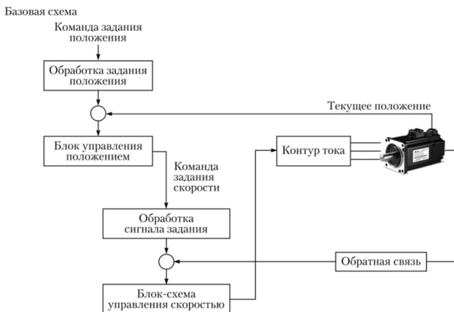
Рисунок 5.10 Блок-схема сервопривода с микропроцессорным управлением
