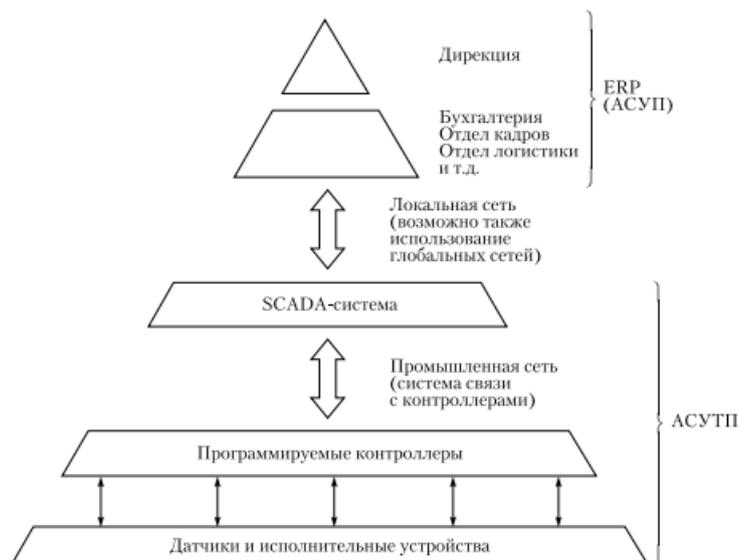
Рисунок 2.3 Обобщенная функциональная схема АСУ
