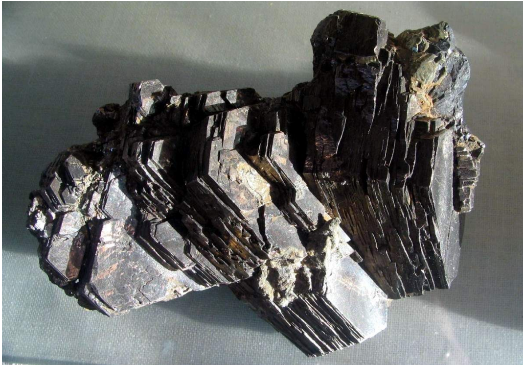
Рис. 8. Весьма совершенная спаянность гипса
