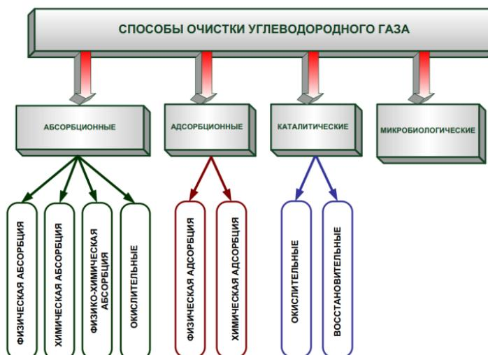
Рисунок 7 – Способы очистки угледородного газа
