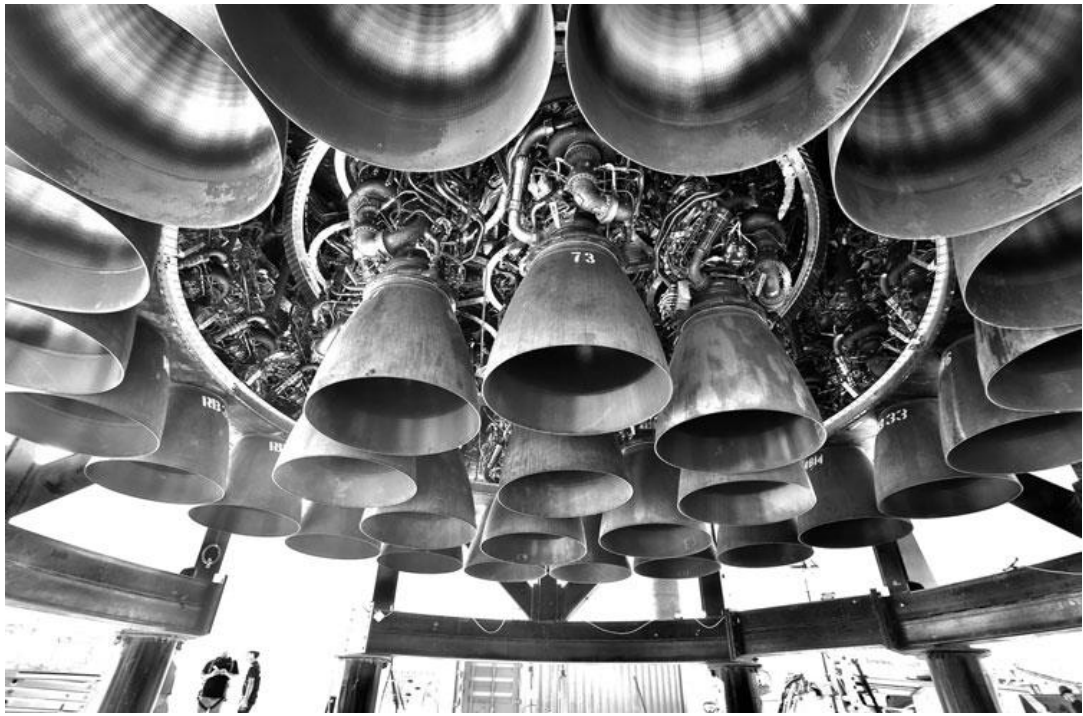
Сопла двигателей Raptor на ускорителе Starship Superheavy Booster. Источник изображения: SpaceX
