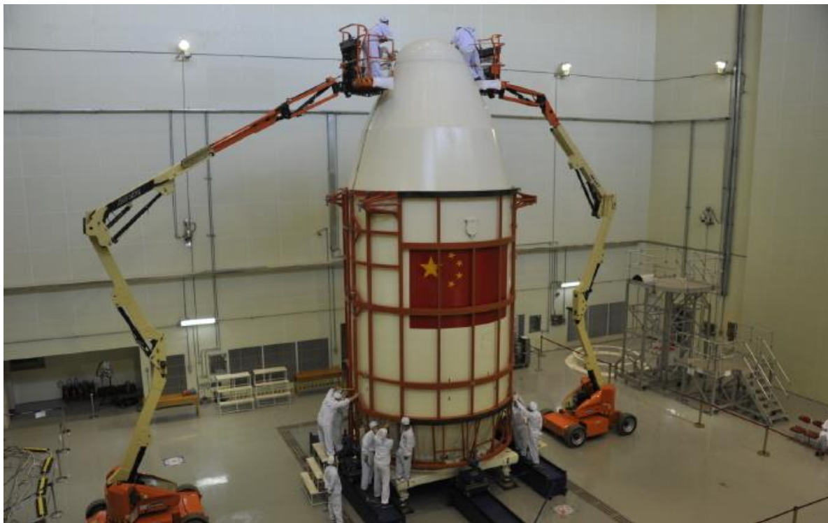
Головной обтекатель РН CZ-2С диаметром 4,2 м © Фото: CASC
