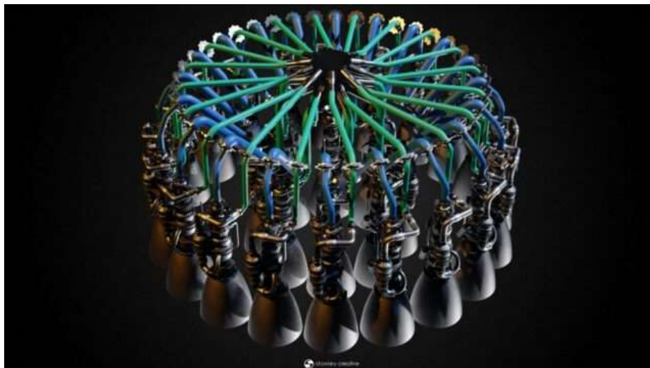
Любительский рендер разводки топливопроводов прототипа ускорителя Super Heavy BN3
