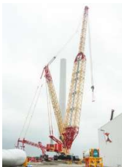
Как может выглядеть кран Liebherr LR 11350 после завершения сборки
