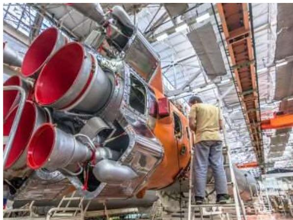
Ракета-носитель «Союз-2.1б» создана в РКЦ «Прогресс» и является модификацией РН «Союз-2». По сравнению с вариантом «1а» она имеет двигатель с повышенными энергетическими характеристиками на третьей ступени. У РН «Союз-2.1б» по отношению к предыдущей версии выше точность выведения, устойчивость и управляемость, увеличена масса полезной нагрузки.
