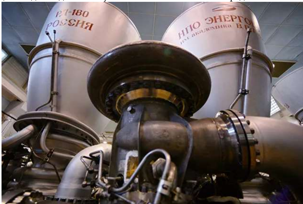
Ракетный двигатель РД-180 в цехе "НПО Энергомаш" в Московской области. © РИА Новости / Сергей Мамонтов
