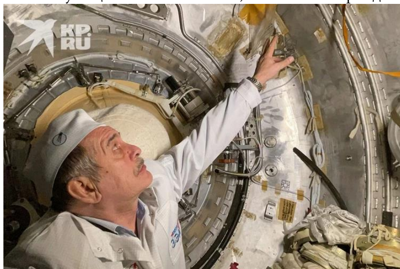
Толщина стенок ПрК всего 4 мм. Но это специальный особо прочный металл/ фото: Александр МИЛКУС
