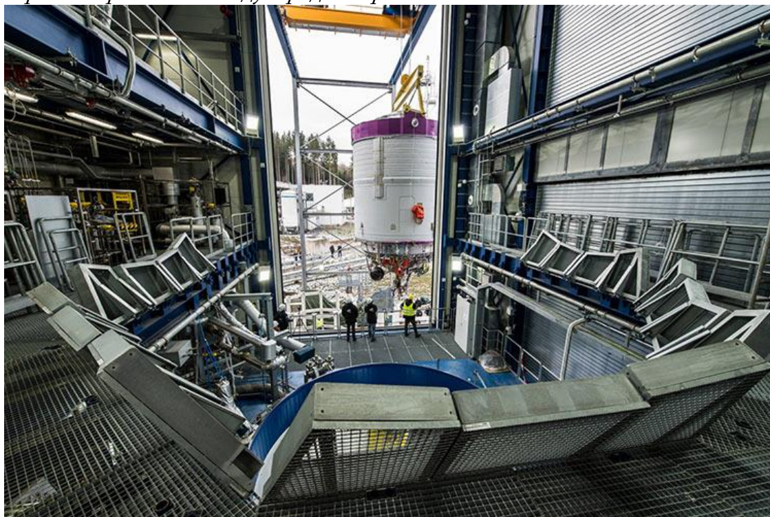
Верхняя ступень Ariane 6 на тестовом стенде/ фото: DLR
