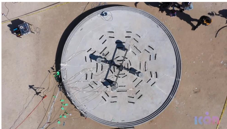
Готовая площадка с установленным тестовым ракетным двигателем, фото ICON
