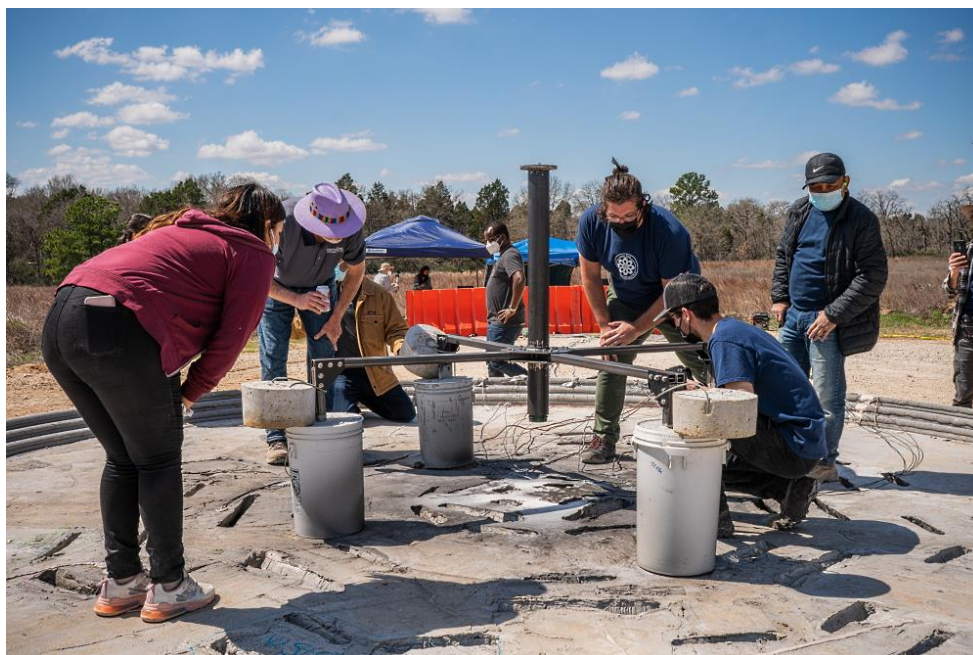
Осмотр площадки после испытаний. Обратите внимание на бортик по краям, отражающий выхлоп вверх.
