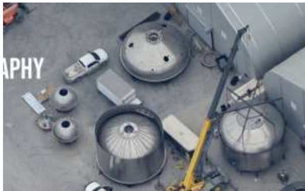
Днище под 3 Raptor Vac, Двигательный отсек SN17, Посадочные баки, опорная шайба
