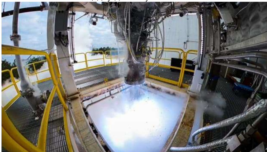
Компания тестирует двигатель Aeon 1, предназначенный для использования на верхней ступени ракеты Terran R, на своём объекте в Центре Стенниса NASA в Миссисипи. Credit: Relativity Space
