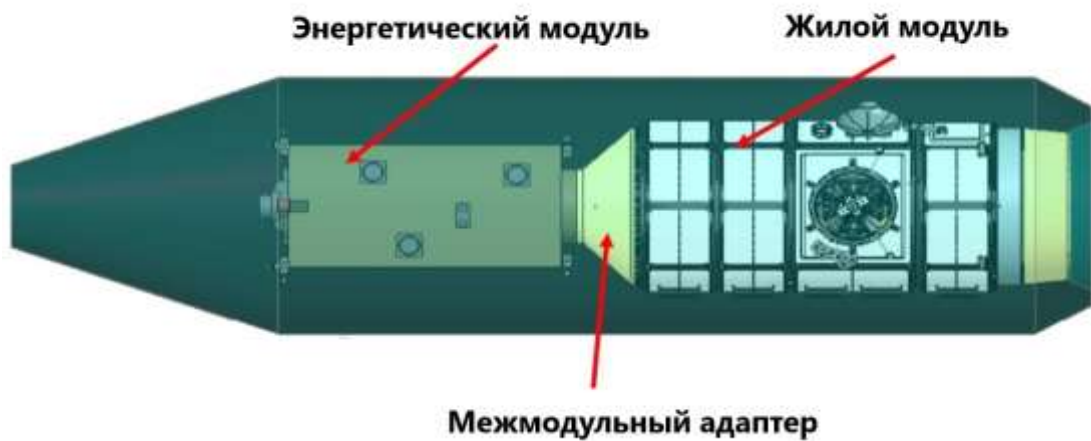
Компоновка модулей под новым обтекателем/ © Northrop Grumman
