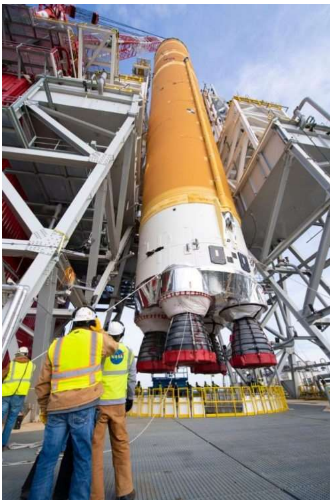
Центральная ступень PH SLS, предназначенная для миссии Artemis-1, в настоящее время проходит заключительные испытания Green Run (фото: NASA)
