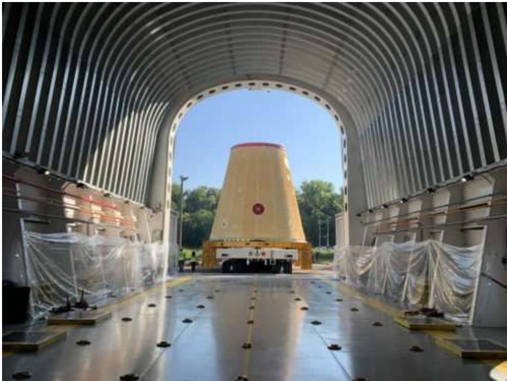
Адаптер ступени ракеты-носителя (LVSA) для миссии Artemis-1 был доставлен в KSC этим летом (фото: NASA)
