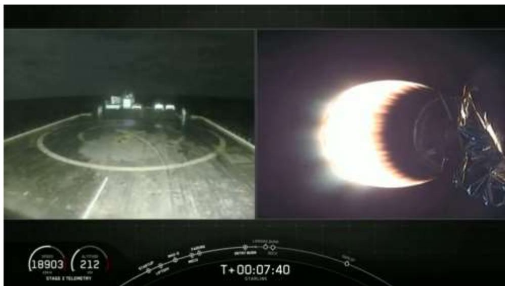
На камере с «разделённым экраном», которая стала обычным явлением для пусков РН Falcon 9, ярко светится вакуумный двигатель второй ступени Merlin 1D+ (справа), в то время как автономная платформа (ASDS) «Just Read the Instructions» (слева) ожидает своего первого «улова» на Восточном побережье в июне 2020 года. Фото: SpaceX
