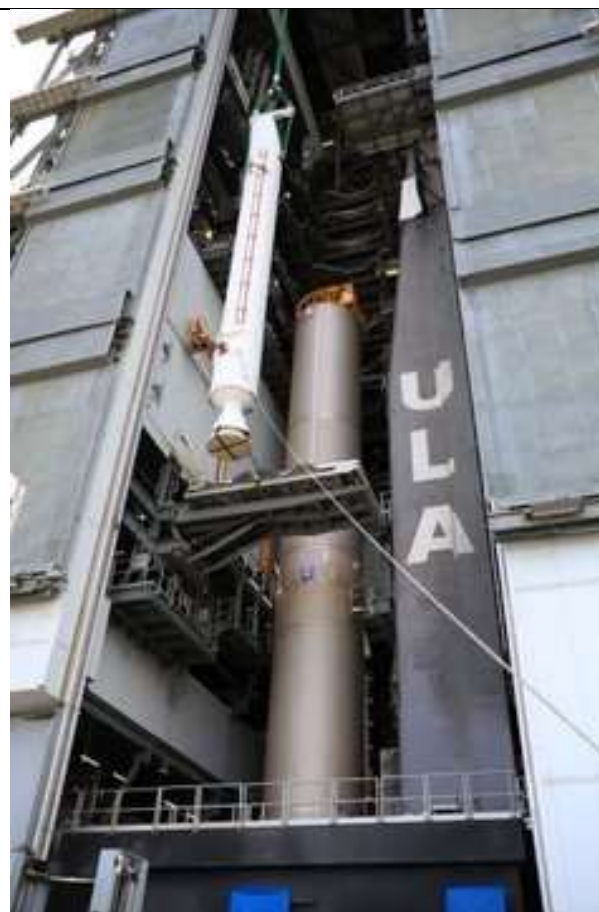
Один из ускорителей GEM-63 нового типа установлен на PH Atlas V Common Core Booster (CCB) для миссии NROL-101 в начале 2020 года. Фото: ULA
