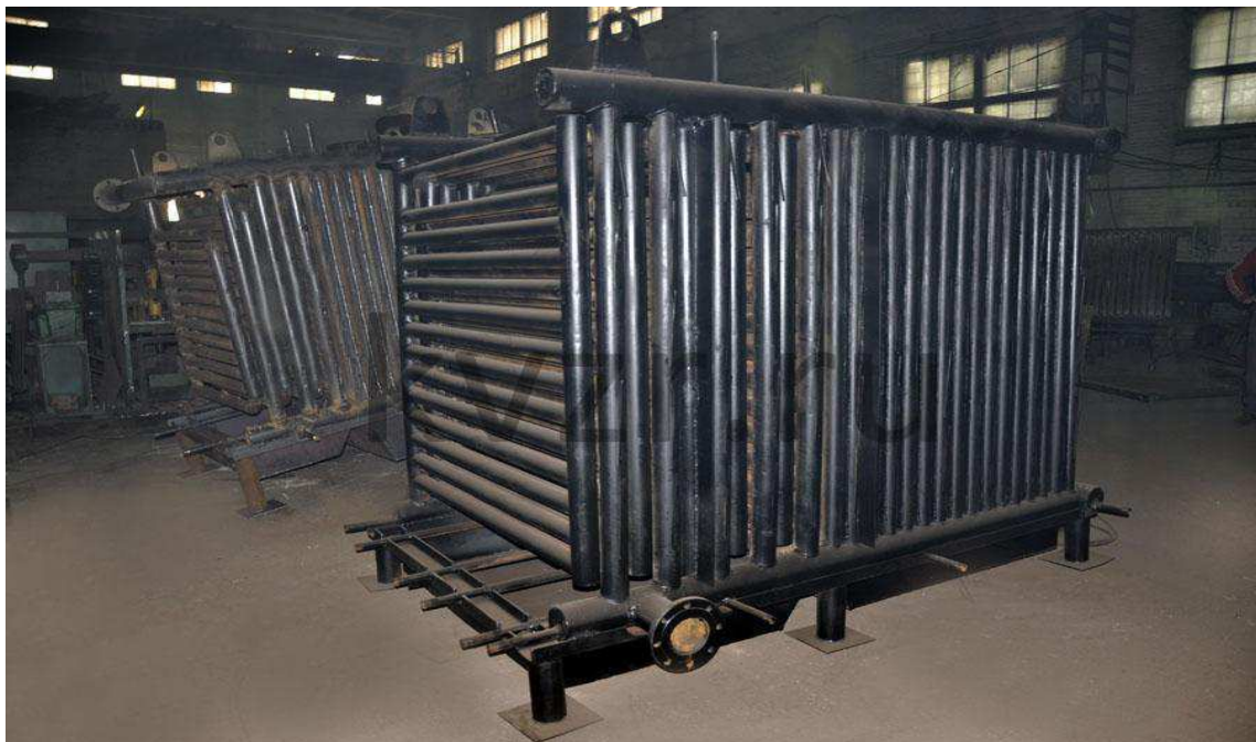
Рисунок 13 – Внешний вид конвективного блока котла
