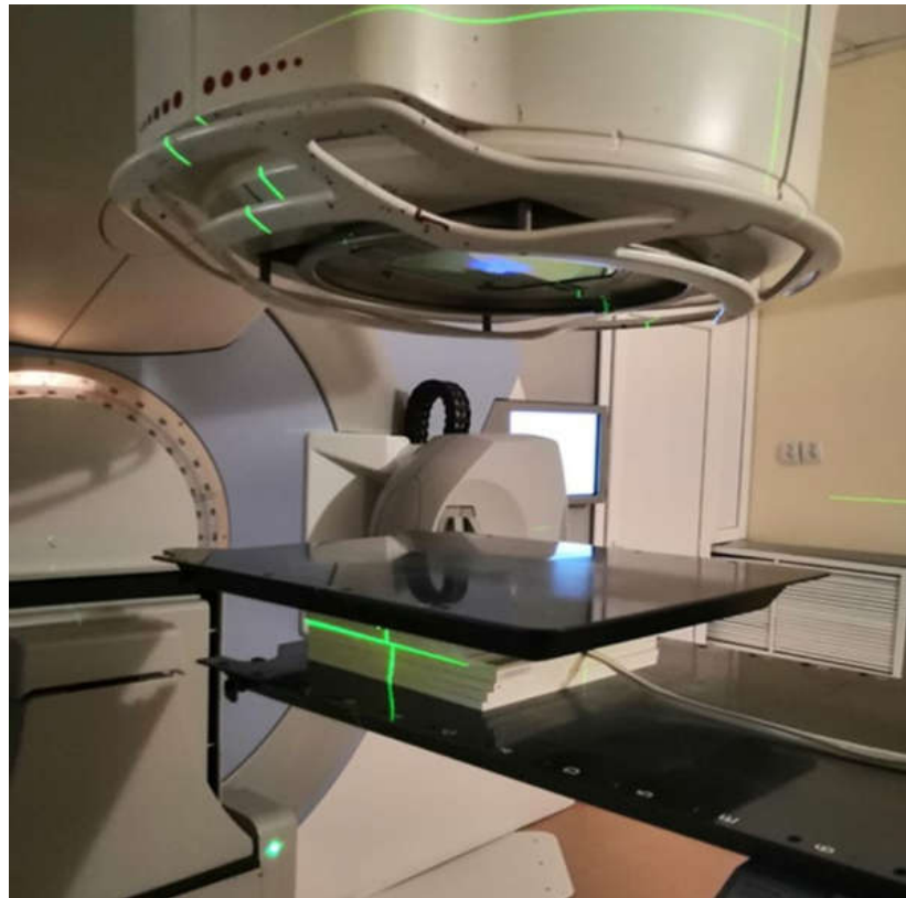
Рисунок 22 – Измерения заряда M_{raw} в фантоме при наличии деки стола
