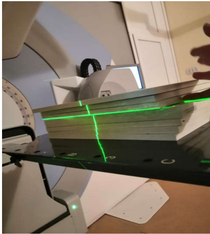
Рисунок 20–Измерение заряда M_{raw} в фантоме при отсутствии терапевтических устройств
