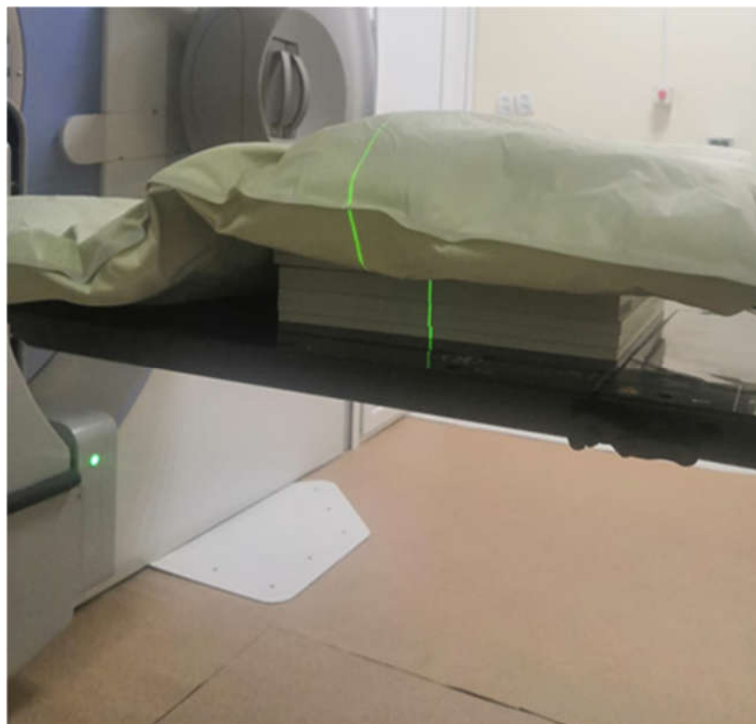
Рисунок 23 – Измерения заряда M_{raw} в фантоме при наличии вакуумного матраса
