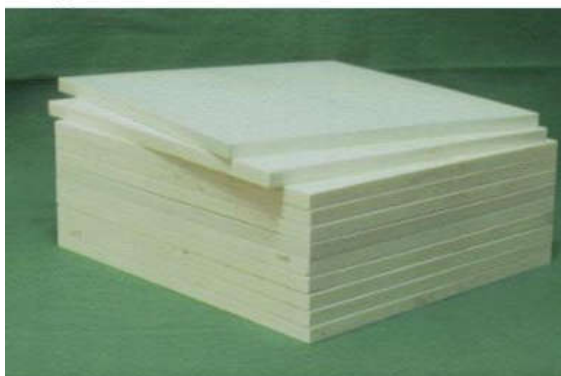
Рисунок 15 – Вид фантома «белая вода», пластины с толщиной – 1 см, 0,5 см, 0,2 см, адаптерная 2 см [9]
