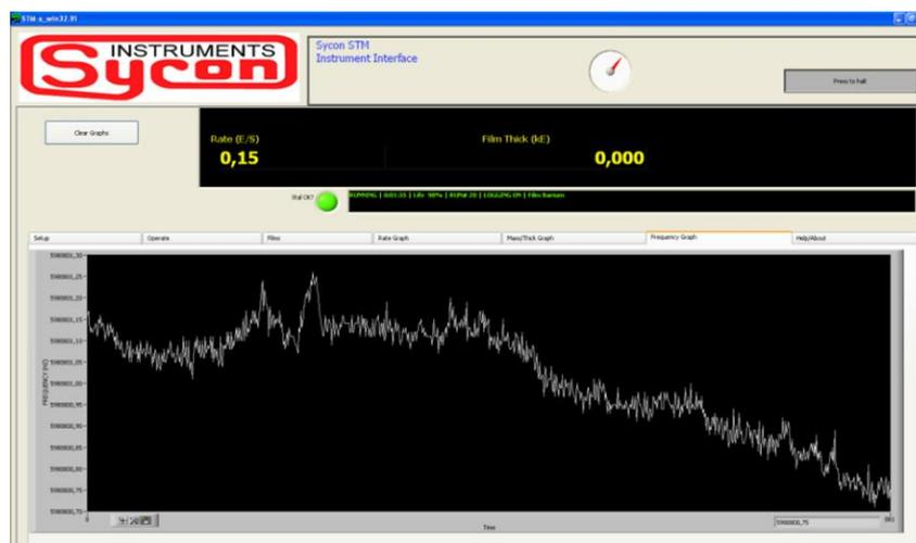
Рисунок 33 – График разностной частоты двух генераторов (эталонного и с кварцевым датчиком) в программе
