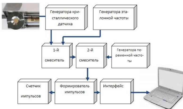
Рисунок 26 – Блок-схема измерителя толщин пленок [33]
