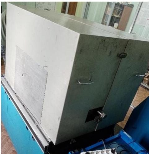
Рисунок 32 – Термокороб для дегазации СВВ камеры
