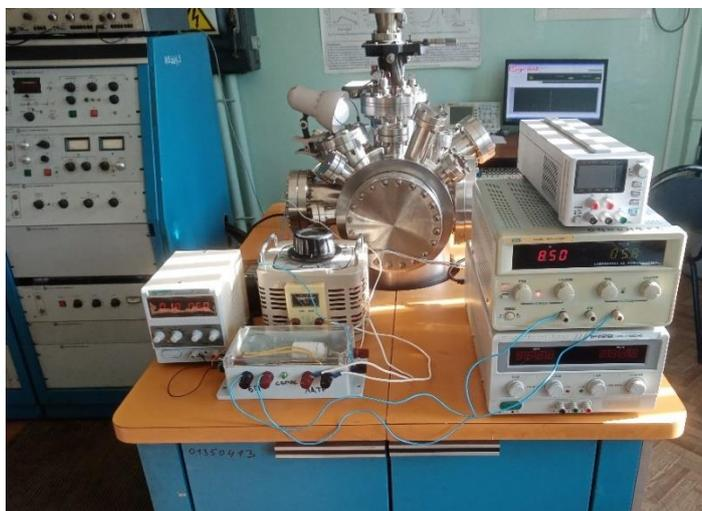
Рисунок 20 – СВВ камера прибора РНІ – 590
