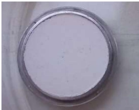
Рисунок 4 – Внешний вид образца для исследования в подложке
