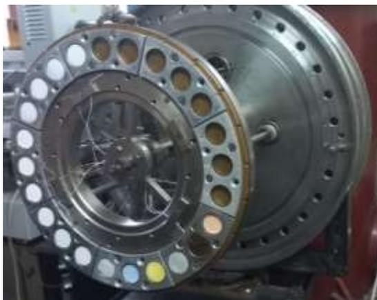
Рисунок 7 – Образцы, закреплённые на поворотном столике 26
