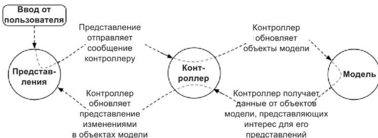
Рисунок 17 – Схема взаимодействия частей архитектуры MVC
