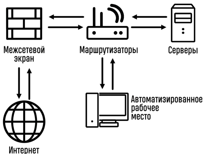
Рисунок 8 — Схема локальной вычислительной сети
