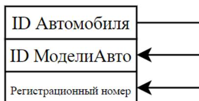
Рисунок 16 – Диаграмма функциональных зависимостей отношения «Автомобили»
