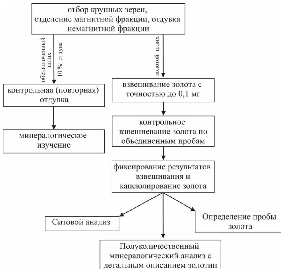
Рисунок 2 – Общая схема обработки шликеров, содержащих полезный компонент в лабораторных условиях.
