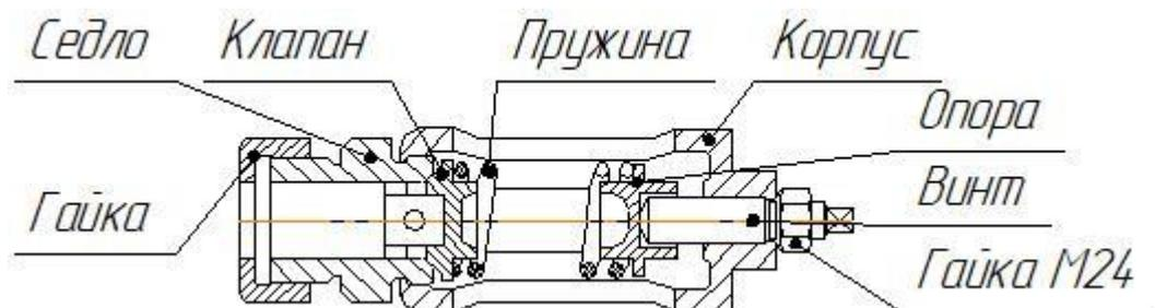
Рисунок 7 – Клапан предохранительный
