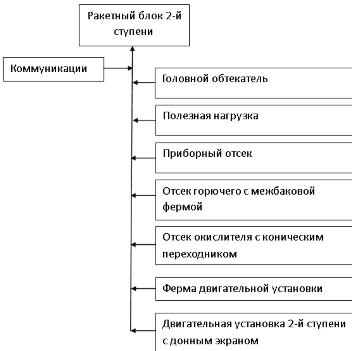
Рисунок 2 – Технологическая схема членения РБ второй ступени
