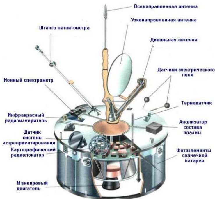
Рисунок 1 – Конструкция Пионер – Венера – 1
